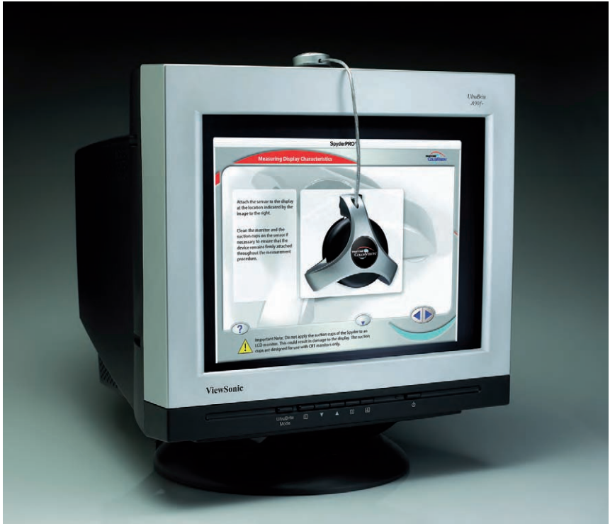
Das Spyder2-Colorimeter kontrolliert, ob die Bildschirmdarstellung noch im Toleranzbereich liegt. Abbildung: Datacolor AG, ColorVision
