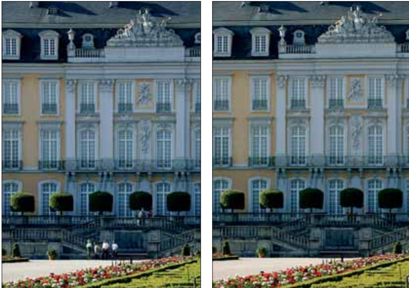
Links: Aufnahme mit der vollformatigen EOS-1Ds und 110mm Brennweite bei Blende 16. Rechts: Aufnahme mit EOS 10D und 70mm Brennweite bei Blende 11. Die Schärfentiefe ist bei beiden Aufnahmen identisch. Durch den etwas kleineren Aufnahmesensor der EOS 10D gewinnt man etwas mehr Schärfentiefe als beim Kleinbildfilm.
