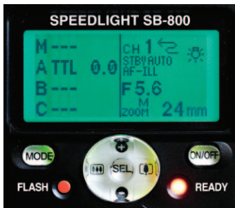
⤴ Masterdisplay mit Gruppe A in TTL ohne Korrektur: Der Master gibt nur ein Steuersignal ab, aber kein Licht für das Motiv.
