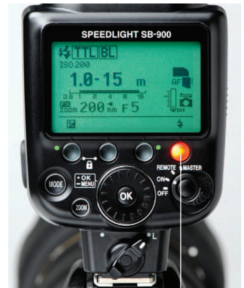
⌞ Bereitschaftsanzeige ④ eines Nikon-Systemblitzgeräts
