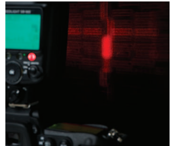
⤴ AF-Hilfslichtprojektion eines SB-900 bei Objektivbrennweite 50 mm, mittleres AF-Messfeld
