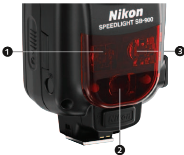
⧘ SB-900 mit seinen AF-Hilfslichtmodulen für den linken ❶, rechten ❷ und mittleren ❸ Fokusbereich
