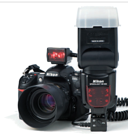
⤴ Das Spiralkabel SC-29 mit AF-Hilfslichtfunktion dient zum entfesselten Blitzen und erleichtert zugleich die Arbeit des Autofokus.
