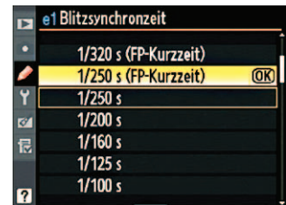
Individualeinstellung FP-Kurzzeitsynchronisation einer Nikon D300
