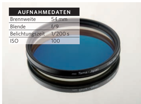
Das Foto eines Polfilters auf einem Spiegel ist übrigens eine wunderbare Möglichkeit, die Qualität des Polfilters zu überprüfen. Beim Drehen des Filters darf sich die Farbe nicht ändern, idealerweise zeigt der Polfilter sogar gar keine Farbe, sondern lediglich ein Neutralgrau, und je dunkler das Neutralgrau ist, desto wirksamer ist der Polfilter.
