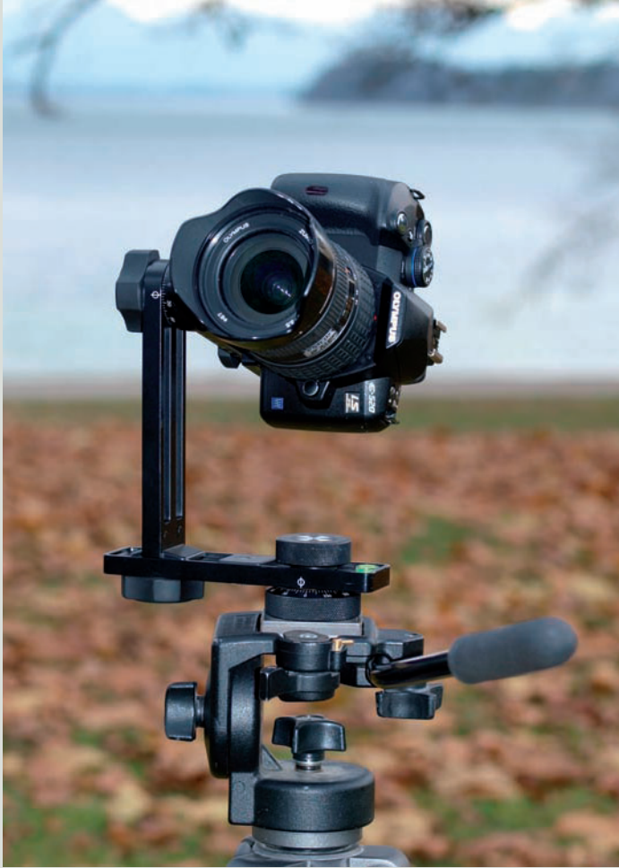
Im Bild sichtbar ist ein Nodal Ninja 3 auf einem Manfrotto-Neiger.
