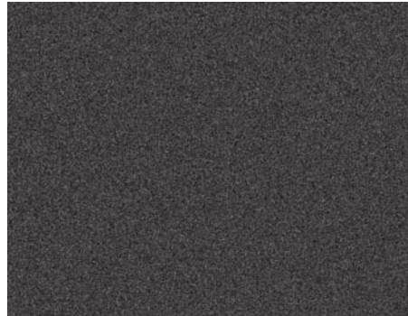
Bildausschnitt: Hier wurde 30 Minuten ein Objektivdeckel belichtet. Der Kontrast wurde maximiert und aufgehellt. Das Ursprungsbild war schlicht schwarz.
