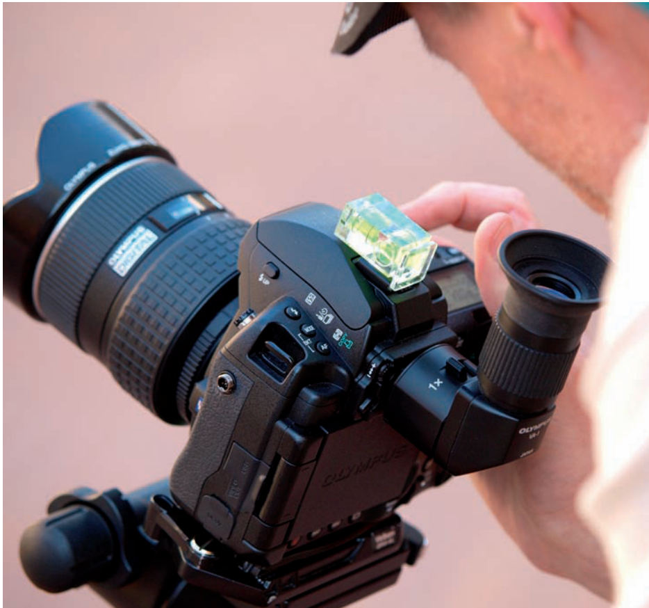
Winkelsucher VA-1 an der E-3 mit Wasserwaage im Einsatz am Stativ bei hellem Licht in San Gimignano.
