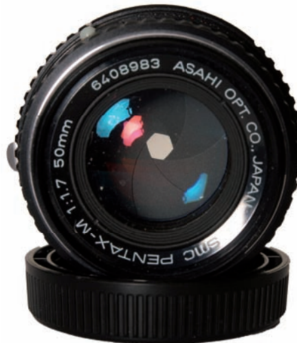
Pentax-Objektiv 50mm, f/1,7. Eingestellte Blende 9. Man sieht deutlich die sichelförmigen Blendenlamellen.
