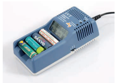
Der Akkulader AV4 lädt drei verschiedene Zellen seit 13 Minuten mit maximal je 1.150 mA, die Zelle in Schacht 3 ist defekt.
