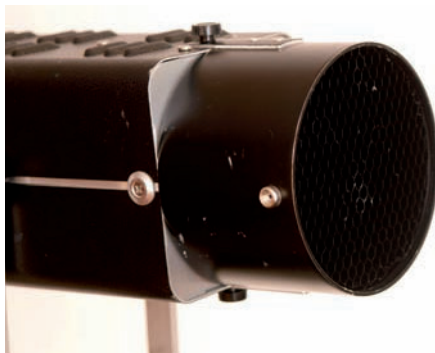
Wabenfilter – da die Waben nicht verspiegelt, sondern schwarz sind, ist der Leistungsverlust an der Wabe sehr hoch. Vorsicht: Schlecht gekühlte Wabenvorsätze werden sehr warm.
