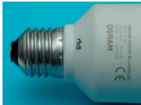
Osram-Energiesparlampe. Kennzahl 827, also 80 % des Spektrums bei 2.700 K Farbtemperatur.
