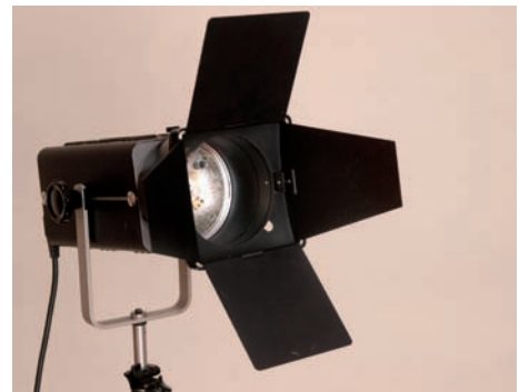
Flügeltor mit vier Flügeln am Multiblitz 202, die Flügel sind vollständig geöffnet. Direkt hinter den Flügeln kann man einen Farbfiler einschieben.
