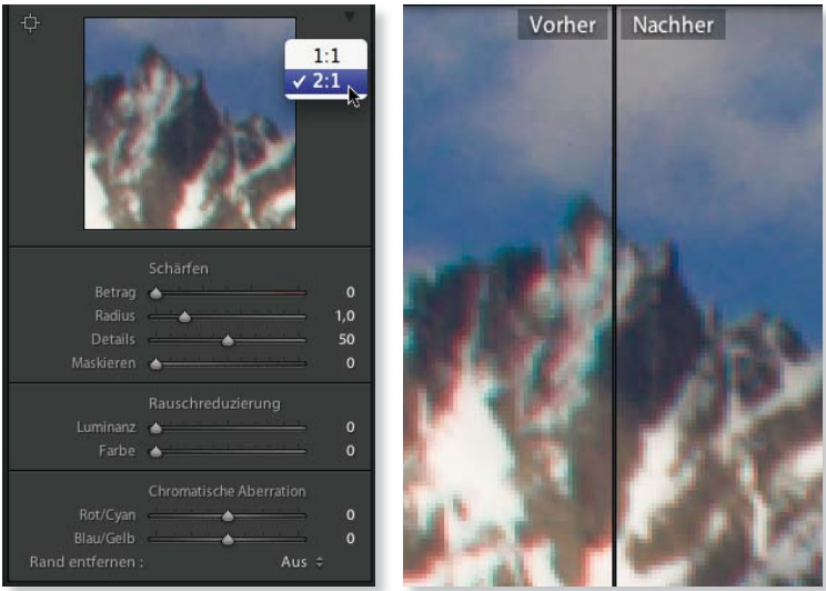
Abbildung 7.34 ►► Die chromatische Aberration mit ihren Farbsäumen (links) und nach der Korrektur (rechts)
