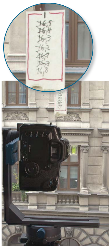
▲ Abbildung 5.27 Messen des Parallaxenfehlers mit einer Markierung auf der Fensterscheibe
