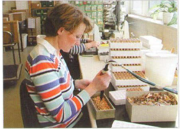
... drehen mit stets gleichbleibender Kraft Kabelschuh-schrauben in das Gewinde
