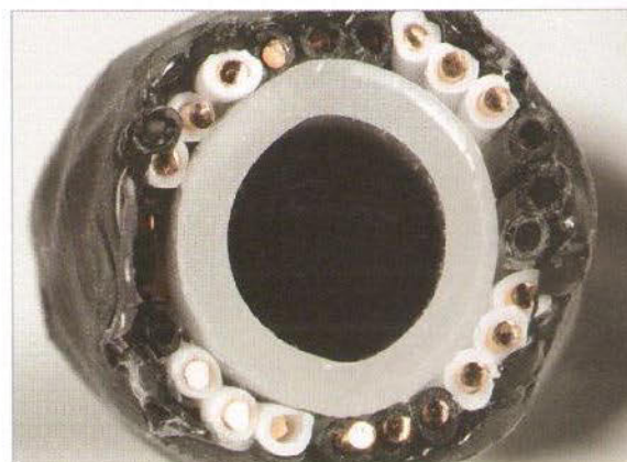
Der Aufbau des Lautsprecherkabels – allzu enge Biegeradien sind allerdings nicht drin
