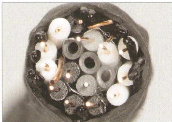
Der innere Aufbau des NF-Kabels: Sehr schön sind die feinen Leiterdrähte zu sehen
