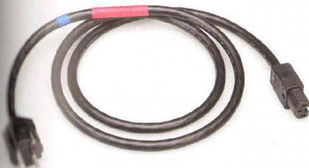
Da das Netzkabel aus klanglichen Gründen nicht geschirmt ist, sollte bei der Installation die Nähe zu signalführenden Leitern vermieden werden
