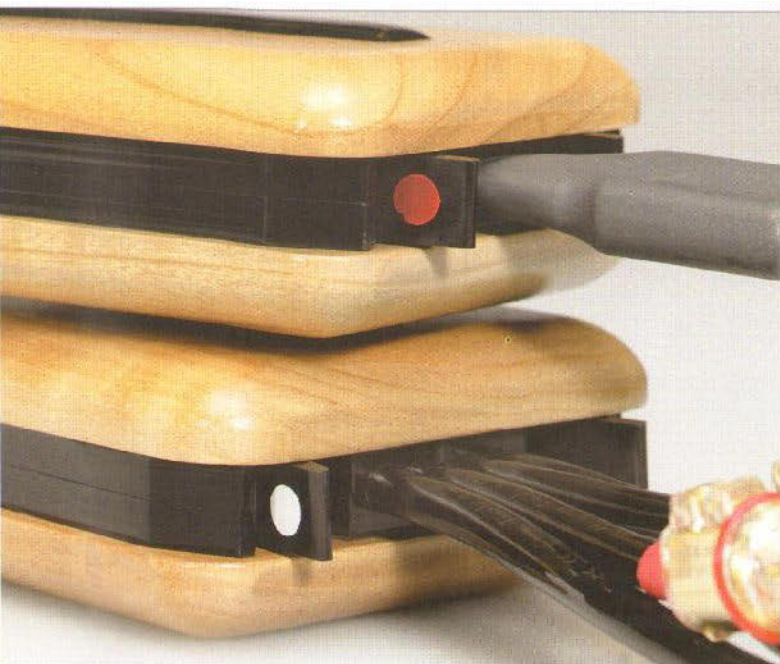
Die Holzkästchen enthalten Spulen und Widerstände, die in den Signalweg geschaltet werden können. Das verändert den Dämpfungsfaktor und damit den Klang
