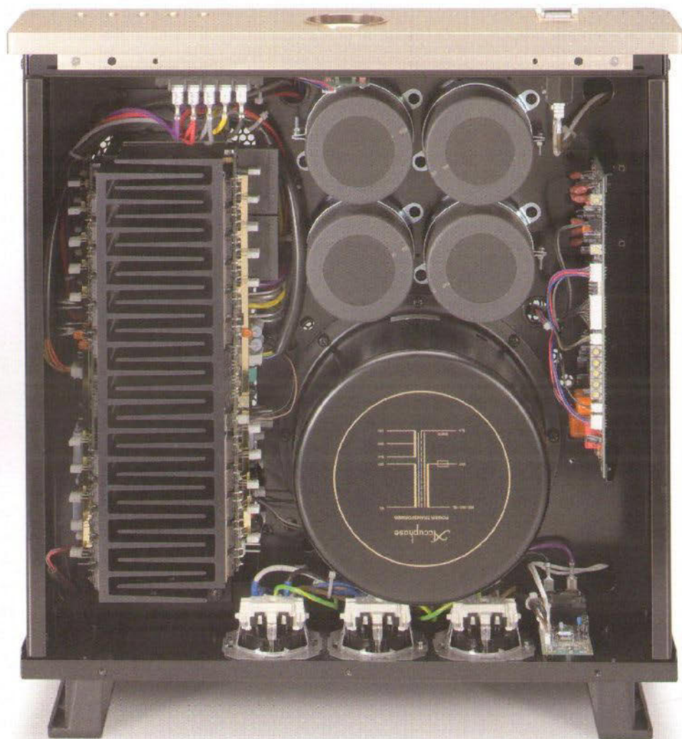
Dominierend im wie üblich höchst stabilen Accuphase-Gehäuse sind der mächtige Ringkerntrafo und die vier großen Siebkapazitäten
