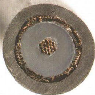
Beim NF-Koaxkabel verdreht Hansen die Stränge beider Kanäle
