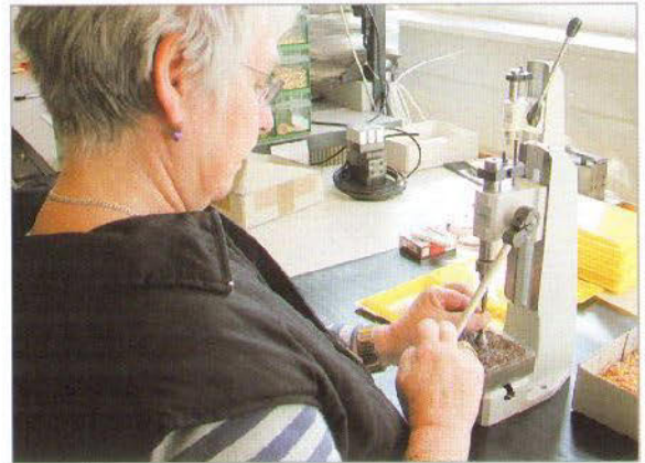
... wie zum Beispiel für Frau Arlt, die hier Koax-Buchsen mit Innenkontakten bestückt
