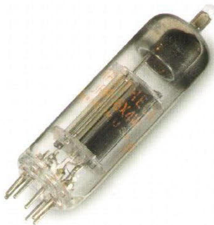
Gleich zwei dieser kleinen Gleichrichterröhren arbeiten im Netzteil des Vorverstärkers
