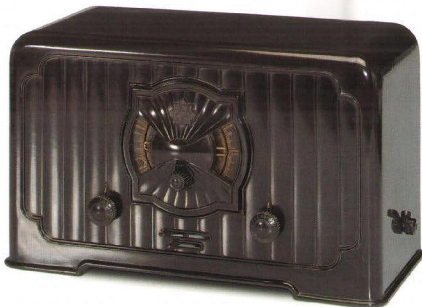
Anfang der 30er Jahre: Telefunken 340W mit dem Spitznamen „Katzenkopf“. In dem charakteristischen Telefunken-Stern dreht sich eine beleuchtete Skala. Damals benutzte man externe, hochohmige Lautsprecher
