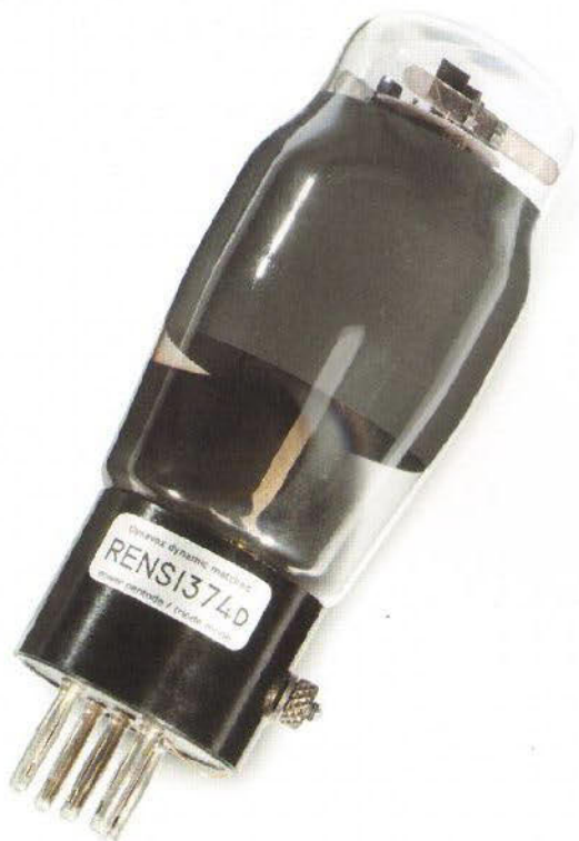
DynaStation 2: Die bereits als „sammelwürdig“ eingestufte Tungram RENS1374d sorgt fürs Ausgangssignal
