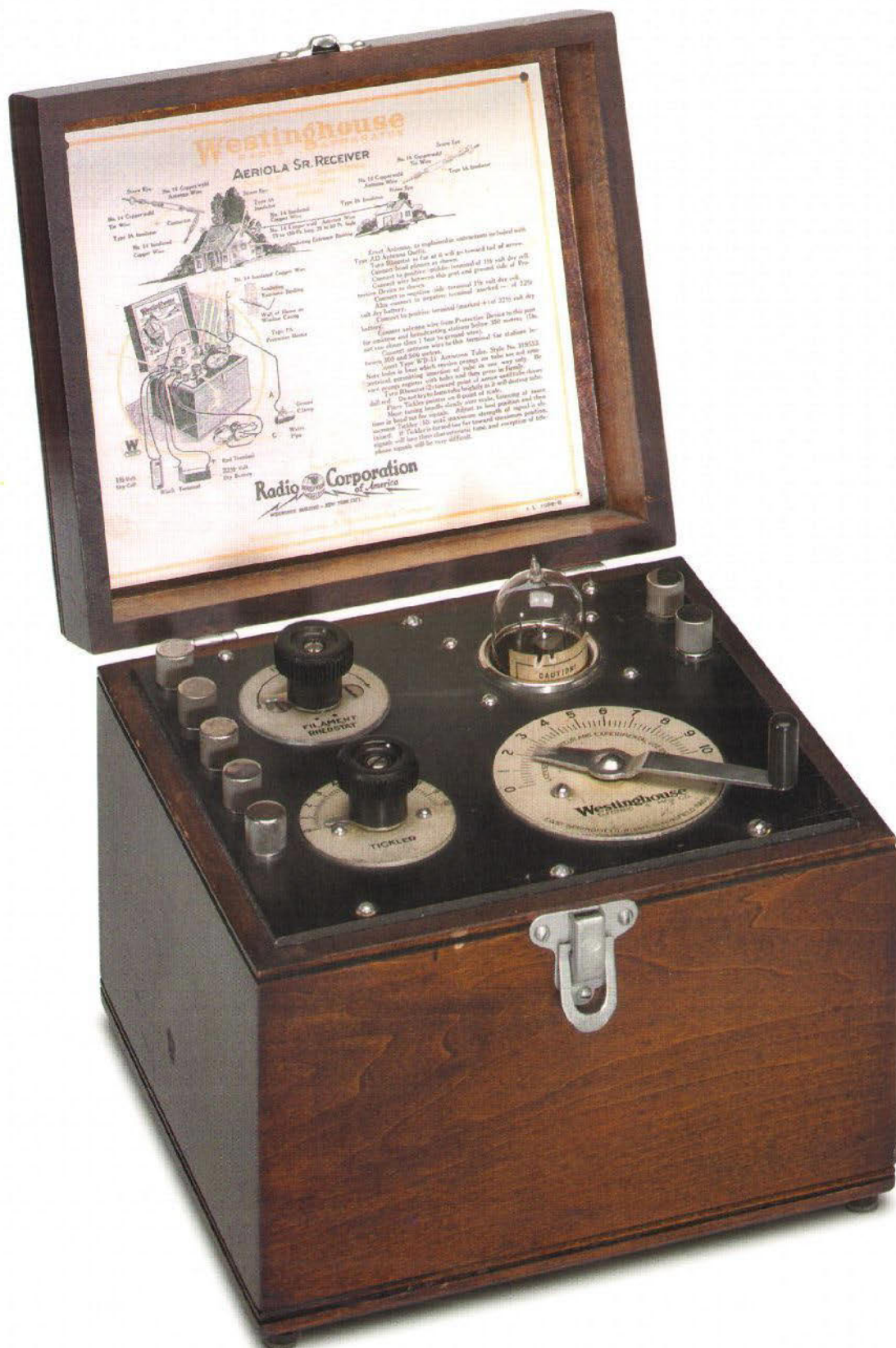
USA: Radio-Frühzeit auf dem Land. Kleine Batterie-Empfänger, die lange Hochantennen benötigten und Kopfhörer versorgten, arbeiteten mit lediglich einer Röhre. Im Deckel die Bedienungsanleitung für Farmer
