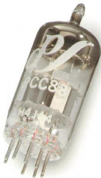
Die in riesigen Stückzahlen hergestellte PCC88 ist eine alte UKW-Doppeltriode. Tim de Paravicini setzt sie – nicht nur – in der Treiberstufe seiner EAR 861 ein
