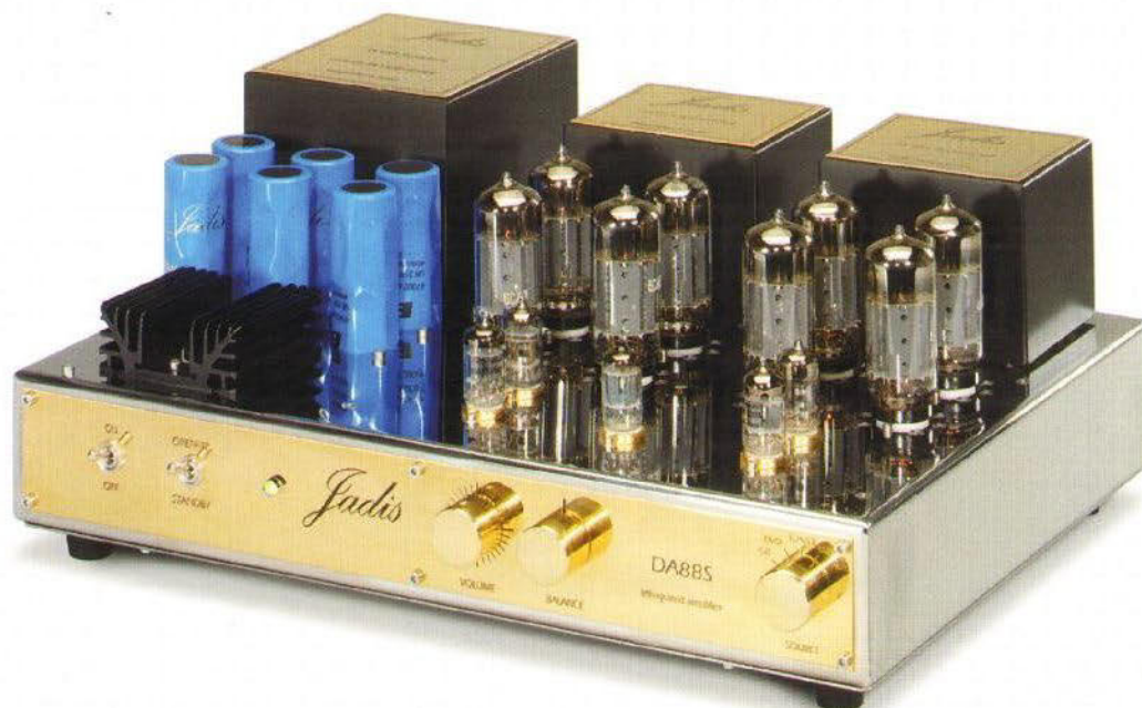
Was bei schwächeren Röhrenverstärkern in kinderlosem Haushalt noch tolerierbar wäre, ist in diesem Fall zwar hübsch anzusehen, angesichts der immensen Hitzeentwicklung aber purer Leichtsinn: der DA-88S „oben ohne“
