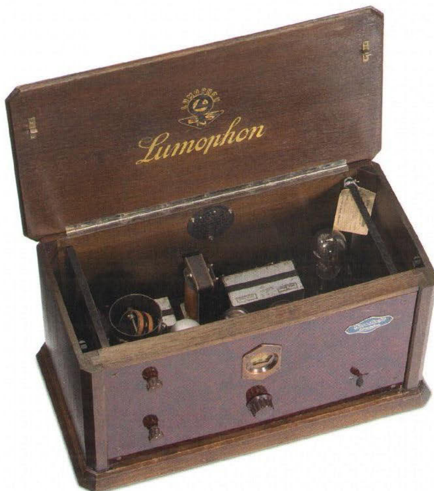
In den 20er Jahren baute man so genannte Truhenradios. Dieses mit vier Röhren bestückte Exemplar namens „Hans Sachs“ entstammt den Lumophon-Werken, Nürnberg. Die Firma wurde 1951 von Grundig übernommen
