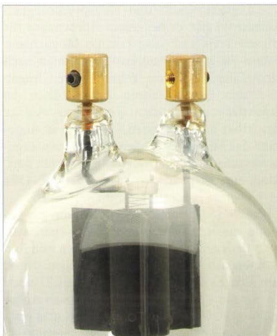
Damit die üblichen Anodenkappen passen – Röhren mit Außenanschlüssen waren früher häufig anzutreffen –, wurden mit Inbusschrauben gesicherte Zwischenstücke auf die eingeschmolzenen Drähte geschoben
