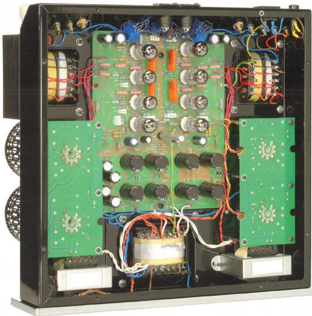
Sieht man mal von der verchromten Front (außen) und diesen neumodischen Platinen (innen) ab, pflegt Tim de Paravicini klassisches spiegelsymmetrisches Dampflokdesign. Zwei ECC83 und sechs PCC88 sorgen in der Eingangs- respektive Treiberstufe für eine korrekte Signalverwaltung
