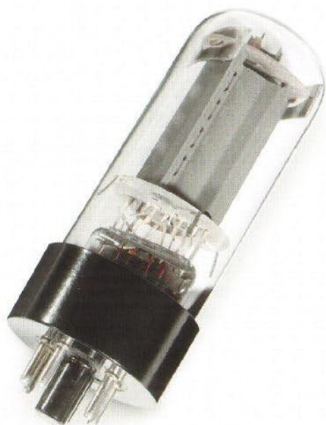
DynaStation 1: In der Ausgangsstufe werkeln zwei EL34 in superschonender Triodenschaltung ...
