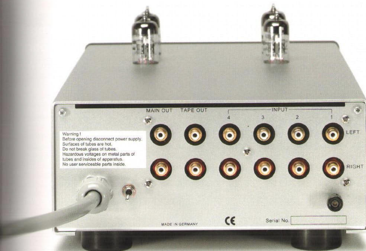
Der Ground-Lift-Schalter neben der Netzzuleitung hat sich in der Praxis als probates Mittel gegen Brummstörungen bewährt. Sogar die Cinchbuchsen hat Fischer nach klanglichen Aspekten ausgewählt
