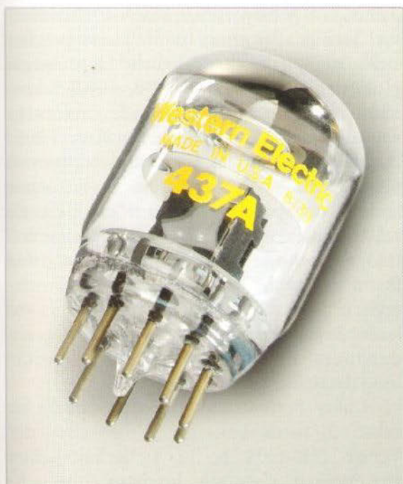
Western Electric 437A: schlicht eine Traumröhre, die natürlich auch ihren Preis hat. Wavac ist meines Wissens nach der einzige Hersteller, der diese Profi-Triode serienmäßig verwendet
