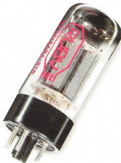
... während als Gleichrichter eine GZ34 von Ruby Tubes – auch als „Tube Amp Doctor“ bekannt – glänzt
