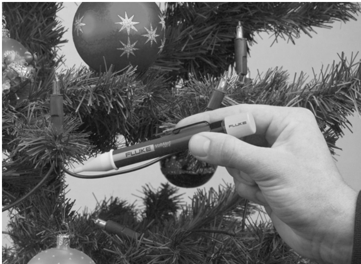
Abb. 10: Der kontaktlose Netzspannungsprüfer „VoltAlert“ von Fluke zeigt durch rotes Aufleuchten seiner Spitze die Anwesenheit einer Spannung, z. B. auch durch die Isolation eines Leiters, an (Foto/Anbieter: Conrad Electronic).
