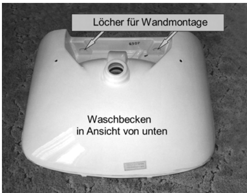
Abb. 91: Kleinere Porzellan-Waschbecken haben meist nur zwei Befestigungs-Löcher (größere Waschbecken bzw. Waschtische haben meist drei Befestigungslöcher). Porzellan-Waschbecken sind schwer und werden bevorzugt mit M8- bis M12-Stockschrauben in Kunststoffdübeln an der Wand befestigt (für kleinere Porzellan-Waschbecken genügen M8-Stockschrauben, für große Porzellan-Waschtische sind M12-Stockschrauben angesagt).
