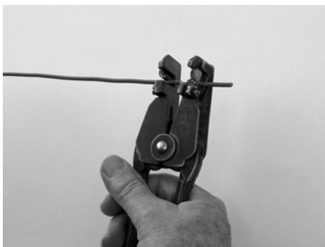
Abb. 132: Automatische Abisolierzange: a) Schneideklingen; b) Einschnitt in die Leiterisolation; c) Abziehen der Isolation vom Leiter
