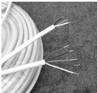
Abb. 69: NYM-J-Kabel sind meist wahlweise mit drei oder mit fünf Adern und mit Kupferleiter-Querschnitt von 1,5 mm 2 oder 2,5 mm 2 erhältlich.
