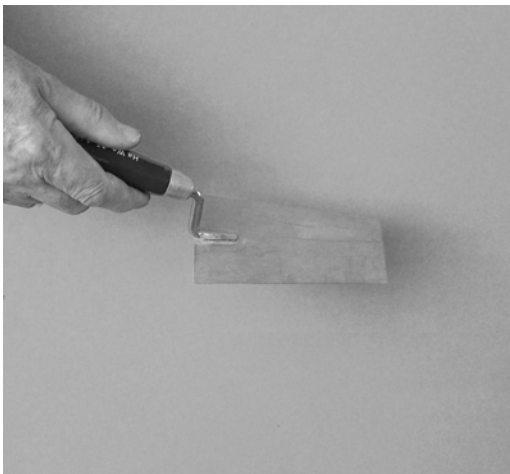
Abb. 146: Mit einer Gips- oder Stuckateurkelle können Leitungen in der Wand mit dem Putz erst grob gefüllt, anschließend glatt verputzt werden.
