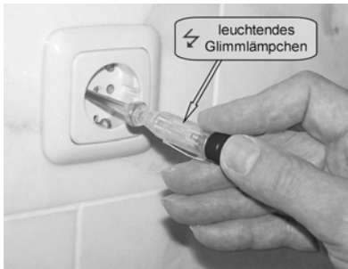
Abb. 9: Durch Anlegen des Daumens an die kleine Kontaktfläche in der Metallkappenmitte eines Billig-Phasenprüfers wird dieser (über den Körper) mit der Erde verbunden und sein Glimmlämpchen im Griff leuchtet auf, wenn seine Klinge die Phase der Netzspannung berührt (Foto/Anbieter: Conrad Electronic).
