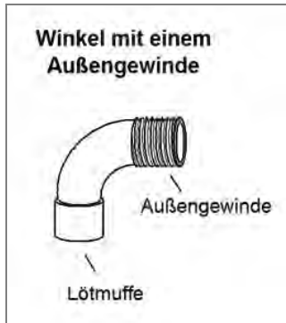
Abb. 84: Winkel-Formstücke für kombinierte Löt-/Schraubverbindungen
