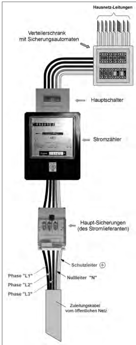
Abb. 95: Hausanschluss mit Stromzähler und Hauptschalter in graphischer Darstellung
