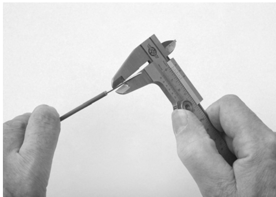
Abb. 79: Mit einem Messschieber kann der Durchmesser eines elektrischen Leiters genau ermittelt werden (den Leiter-Querschnitt, mit dem in der Elektrotechnik gerechnet wird, kann dann der Tabelle II werden).
