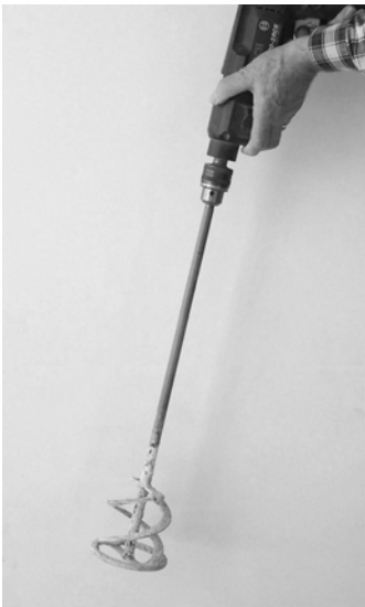
Abb. 145: Putz kann mit einem Rührer und einer Bohrmaschine (ab ca. 800 Watt) bei niedriger Drehzahl in einem Baueimer gemischt werden.
