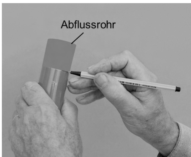
Abb. 99: Ein Streifen Papier, der bündig um das Rohr herumgewickelt wird, erleichtert Ihnen das Einzeichnen einer Linie, an die Sie sich beim Rohrab-schneiden halten können
