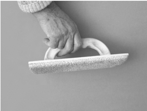
Abb. 148: Mit Hilfe einer Glättescheibe mit Schwamm- gummibelag wird die verputzte Wand geglättet.
