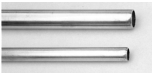
Handelsübliche Standard-Außendurchmesser der Kupferrohre in Stangen: \varnothing 6 mm – 8 mm – 10 mm – 12 mm – 15 mm – 18 mm – 22 mm – 28 mm – 35 mm – 42 mm und 54 mm
