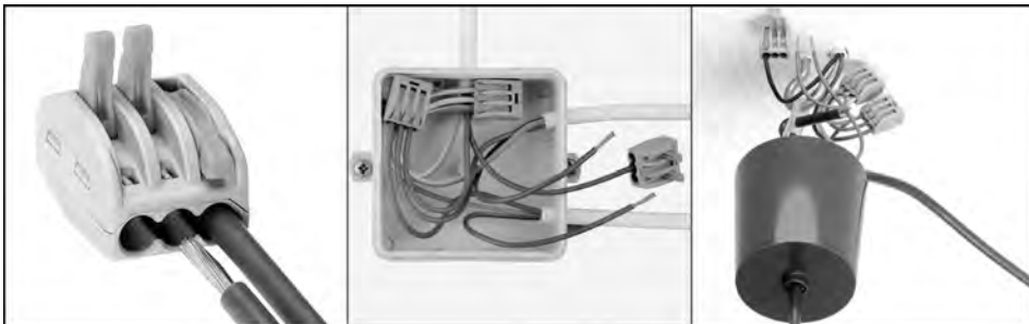
Abb. 138: Verbindungsklemmen mit Betätigungshebeln: Anstelle von Befestigungsschrauben drücken hier spezielle Befestigungshebel die Leiter in der Klemme fest (Anbieter/Foto: Conrad Electronic).
