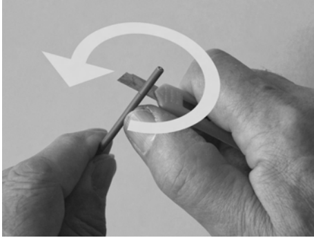
Abb. 130: Die PVC-Ummantelung des Leiters wird ringförmig angeschnitten.
