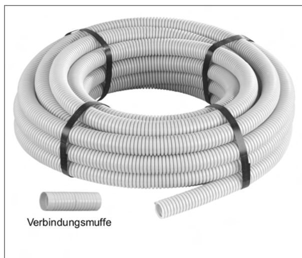
Abb. 64: FFKU-Rohr: Biegsames beiges Kunststoff-Isolierrohr aus PVC, leichte Druckfestigkeit, sehr biegsam ohne Querschnittverengung, geeignet für leichte Unterputz- und Hohlwand-Installationen, Material PVC-U (Foto/Anbieter: Conrad-Electronic).
