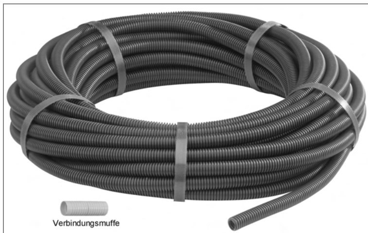
Abb. 65: Panzerrohr: Biegsames schwarzes Kunststoff-Isolierrohr aus Polyolefin, leichte Druckfestigkeit, sehr biegsam ohne Querschnittverengung, verträgt höhere Temperaturen, leichtere mechanische Belastungen und ist geeignet für Unterputz- und Hohlwand-Installationen (Foto/Anbieter: Conrad-Electronic).
