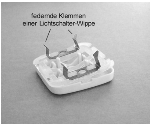
Abb. 41: Großflächige Lichtschalter-Wippen sind in den Wand-Lichtschaltern meistens nur federnd eingedrückt und können mit etwas Krafteinsatz aus dem Lichtschalter einfach herausgezogen werden.
