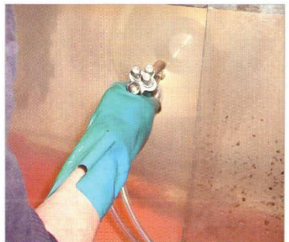
Unter einer Absaugeinrichtung wird eine rotierende Folie mit Silber besprüht
