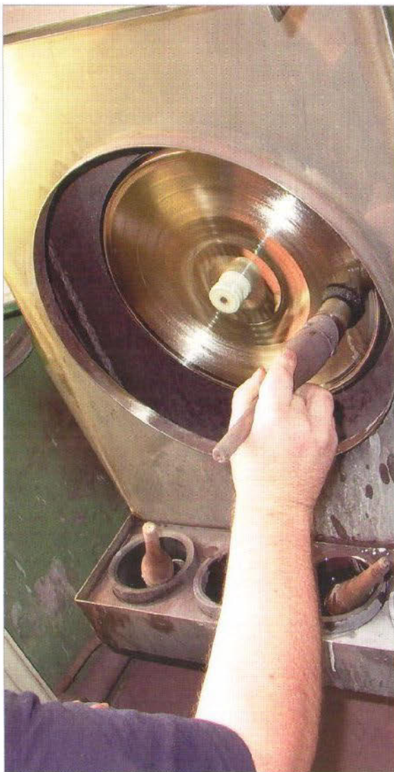
Die fertige Matrize wird sorgfältig in vier Schritten gereinigt, erst dann kommt sie ins Presswerk
