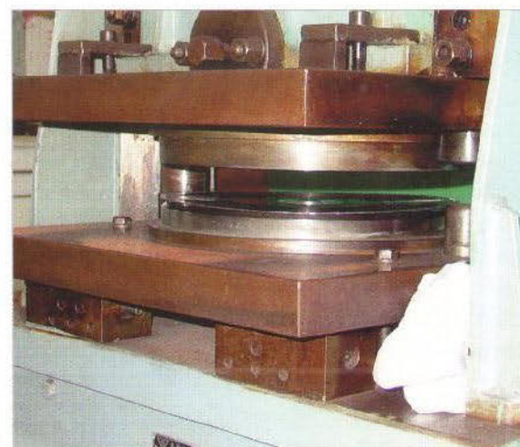
Diese Presse formt die Matrize so, dass später beim Pressen der Platte am Rand eine Wulst entsteht
