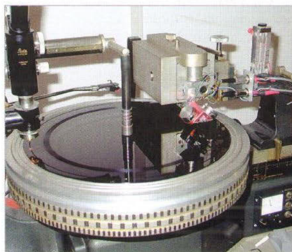
Von der hier geschnittenen Folie wird die Platte produziert, die kleine auf dem Bild links dient Tests
