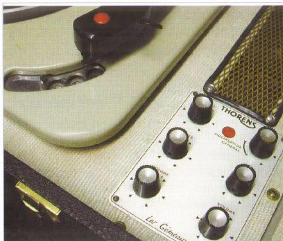
Kurz nach dem reibradgetriebenen mechanischen Meisterwerk TD 124 kam dessen Automatikvariante TD 184 auf den Markt. Die drei gängigen Plattendurchmesser (30, 25 und 17 cm) konnten über einen der Telefonwählscheibe ähnlichen Schalter bestimmt werden. Der TD 184 steckte auch im Koffergerät „Les Gêmeaux“ („Die Zwillinge“ – eine Anspielung an die beiden Stereolautsprecher). Die mit einem Röhrenverstärker ausgerüstete Kompaktanlage bediente man kanalgetrennt, da Tandempotis in der Stereo-Frühzeit noch nicht lieferbar waren
