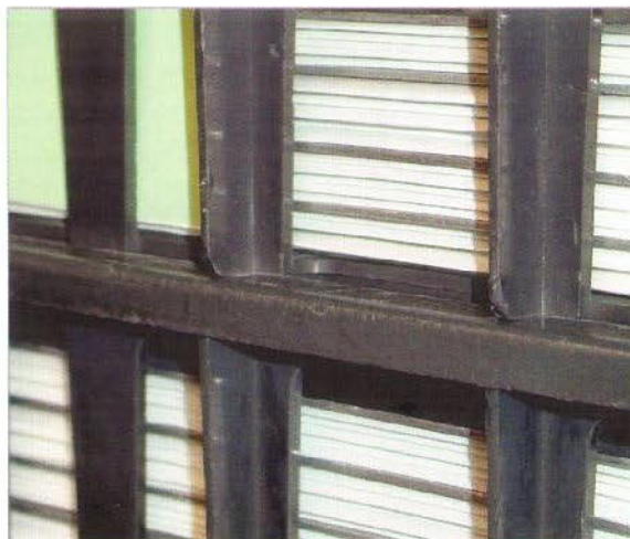
Die frisch gepressten LPs kühlen mindestens 24 Stunden aus. Aluminiumplatten nehmen die Wärme auf
