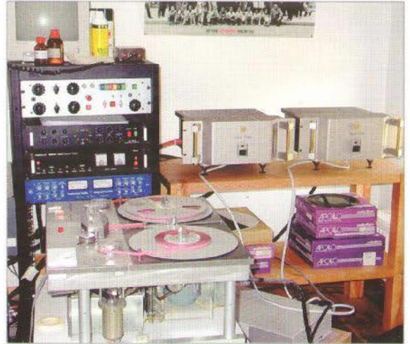
Die M15-Bandmaschine und die Higher Fidelity beziehen den Strom von einem Isotec Power Conditioner
