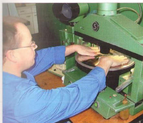
Hier wird eine Matrize anhand der Auslaufrille zentriert, bevor man das Mittelloch stanzt
