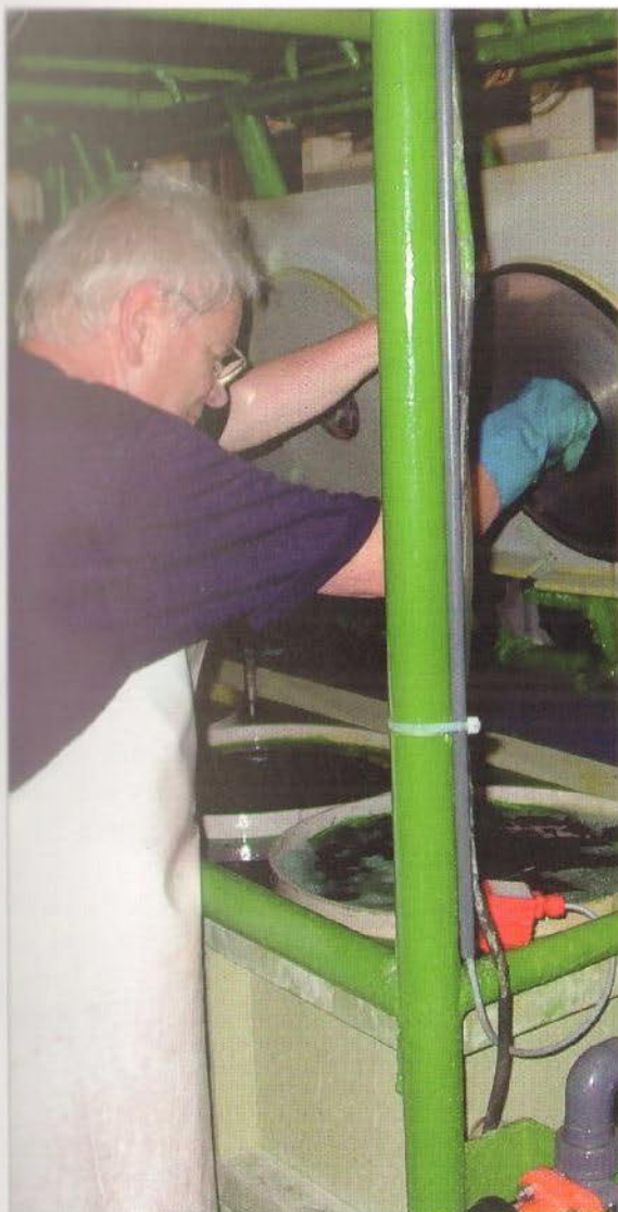
Jürgen Holtermann fixiert die vorvernickelte Folie fürs galvanische Bad, in dem der „Vater“ erzeugt wird
