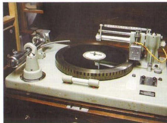
Das Glanzstück von Weichlers Sammlung: die Plattenschneidemaschine R 26 PV. Sie ist ein Dokument der Nachkriegszeit, hergestellt von Thorens im Auftrag der Schweizer PTT („Post, Telefon, Telegrafie“). Damit konnten Aufnahmen auf Plattenmaterial aller Art angefertigt werden – aus Kunstharz oder aus mit Celluloselack oder Gelatine überzogenem Metall oder Glas
