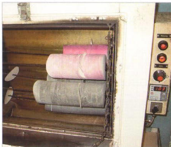
Die Etiketten werden in einem Klimaschrank auf Temperatur gebracht, bevor sie in die Presse gelangen
