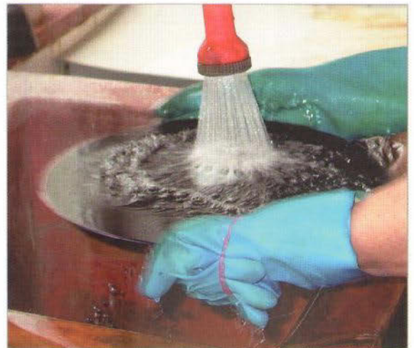
Nach jedem Bad werden die Folien sehr sorgfältig mit destilliertem Wasser abgespült
