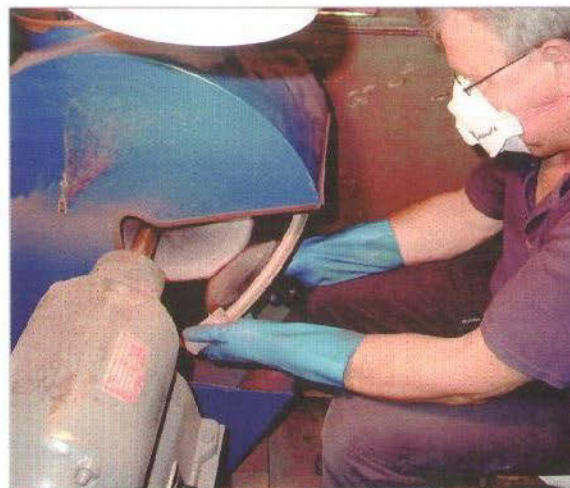
Die Oberfläche einer „Mutter“ wird mit viel Fingerspitzengefühl poliert
