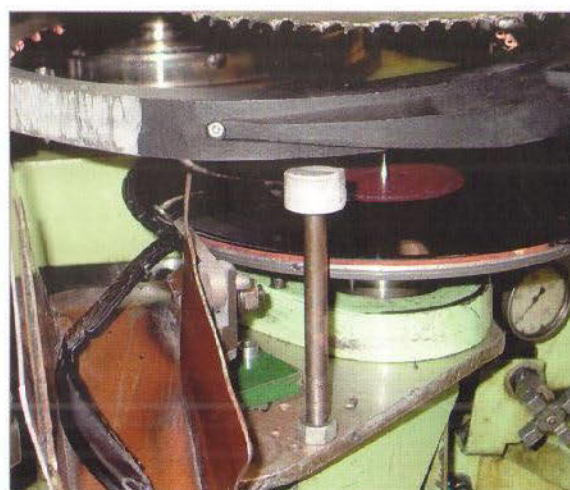
Der Rand der ansonsten fertigen Platte wird beschnitten, das überschüssige Vinyl wiederverwendet
