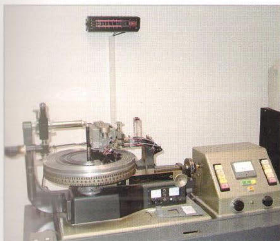
Bei Organic Music kommt eine stark modifizierte Neuemann VMS 70 zum Einsatz
