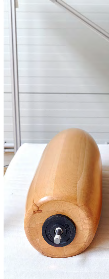
Roll together. Die Walze rollt für diese Prüfung so lange auf die andere zu, bis sie wie von selbst gegeneinander rollen.
