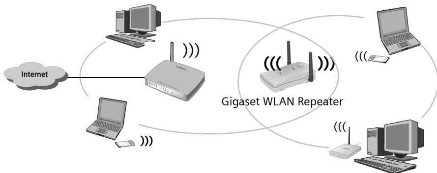
PCs, die über einen Gigaset WLAN Repeater in ein kabelloses lokales Netzwerk eingebunden werden sollen, müssen mit einem kabellosen Netzwerkadapter ausgestattet sein.
