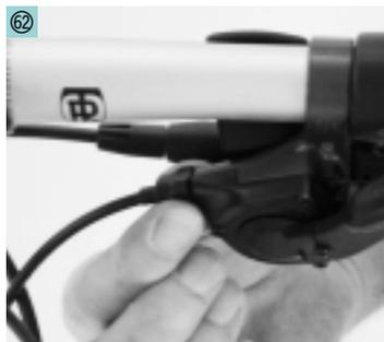
**Wichtig:** Moderne Kettenschaltungen sind unter Tretlast schaltbar. Dies ist beispielsweise bei Schaltvorgängen am Berg von Nutzen, da Sie ansonsten wertvollen Schwung verlieren würden. Trotzdem sollten Sie beim Gangwechsel kurzzeitig den Druck auf die Pedale reduzieren. Einerseits wird dadurch der Schaltvorgang noch präziser, andererseits lässt sich auf diese Weise der Ketten- und Ritzelverschleiß erheblich vermindern.
