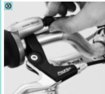
Im 2. Gang muss der markierte Balken zwischen den Markierungsstrichen stehen. Wenn nicht: Mit Einstellschraube am Schaltgriff korrigieren. *Bild 30*
