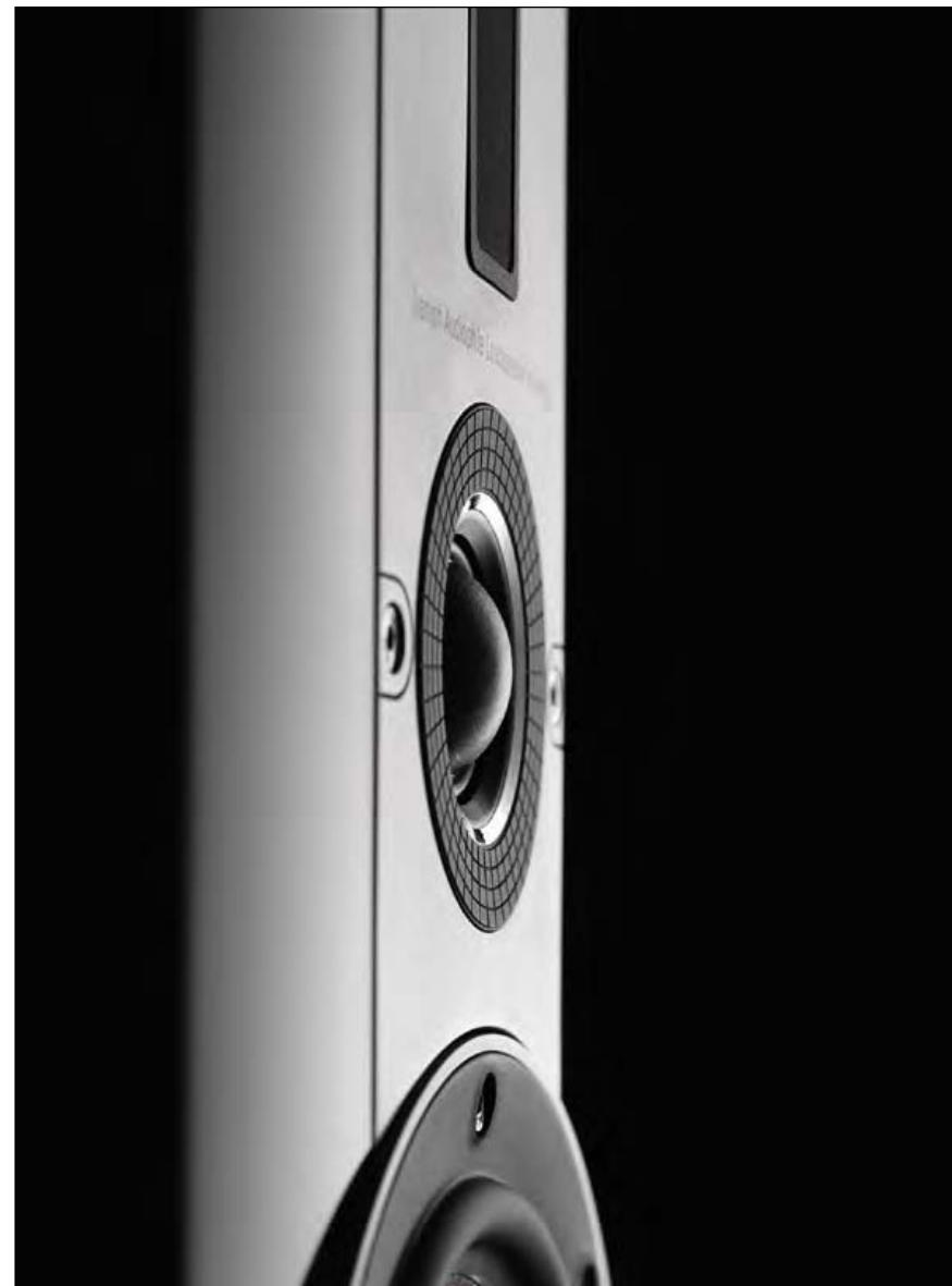
Die 29 Millimeter große, aber dennoch federleichte Gewebekalotte ist äußerst belastbar. Ein besonders dünnflüssiges magnetisches Fluid im Luftspalt kühlte den Antrieb
