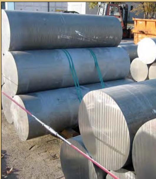
Mit unglaublich hohem Druck werden die drei Tonnen schweren Aluminiumblöcke durch eine Form gepresst
