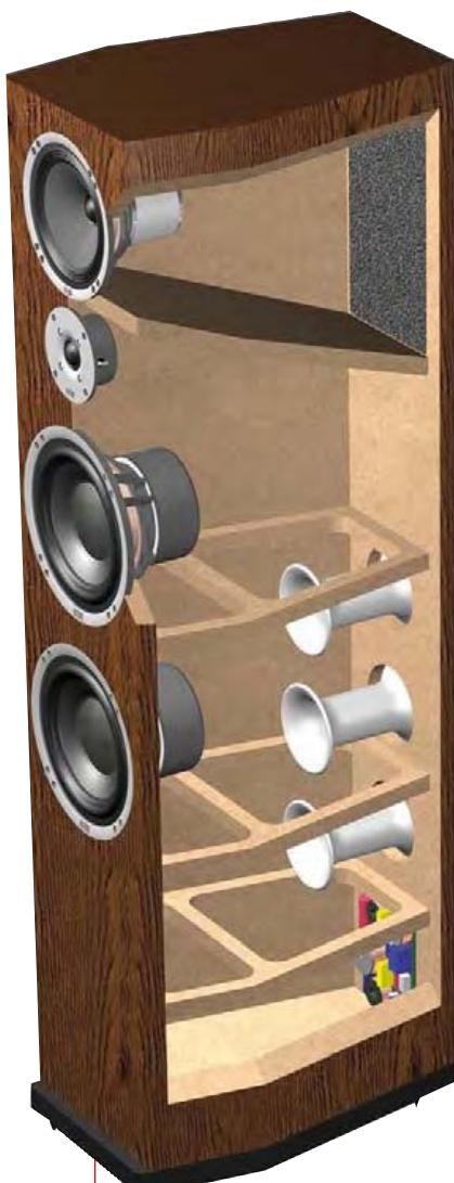
Das Gehäuse aus Holzfaserplatten mittlerer Dichte (MDF) ist aufwendig verstellt und optimal bedämpft. Der 43 kg schwere Lautsprecher steht wahlweise auf Gummifüßen oder höhenverstellbaren Spikes
