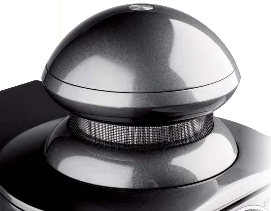
Warum aber noch der Ringstrahl-Hochtöner on top, wenn bereits das Jet-Prinzip in allerhöchsten Tönen schwelgt? Der Grund ist, dass auch der Jet ab etwa 10 Kilohertz den Schall zu bündeln beginnt. Der Bändchen-Rundstrahler bewirkt zudem, dass sich das Schallfeld von den Klangmöbeln löst.
