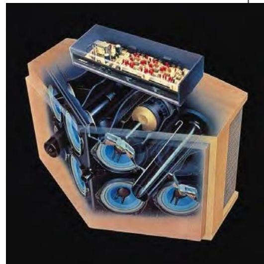
Der Blick ins Innere der „901“: Lediglich ein Lautsprecher gibt den Schall nach vorn in Richtung des Hörers ab, die übrigen acht Chassis sind allesamt nach hinten gerichtet – und liefern so die 89 Prozent indirekten Schall
