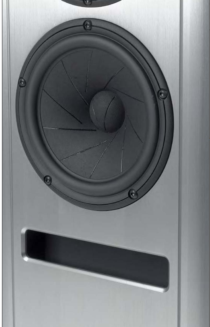
Die beiden flinken Tieftöner arbeiten in einem gemeinsamen Volumen mit der schmalen, rechteckigen Reflexöffnung. Die unregelmäßigen Schlitze auf den Membranen werden mit einem Spezialverfahren verklebt – damit sind die Chassis beinahe resonanzfrei
