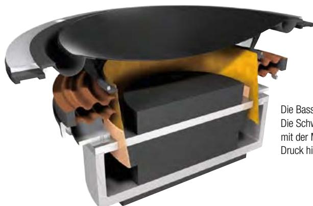
Die Basstreiber wurden speziell für die Blade entwickelt. Die Schwingspule ist über ein belüftetes Kopplersystem mit der Membran verbunden. Dadurch kann sich kein Druck hinter der Membran aufbauen
