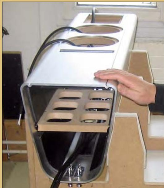
Das Gehäuse wird mit Holzfaserplatten verstärkt, die Schallwand, der Boden und der Deckel daraufgesetzt
