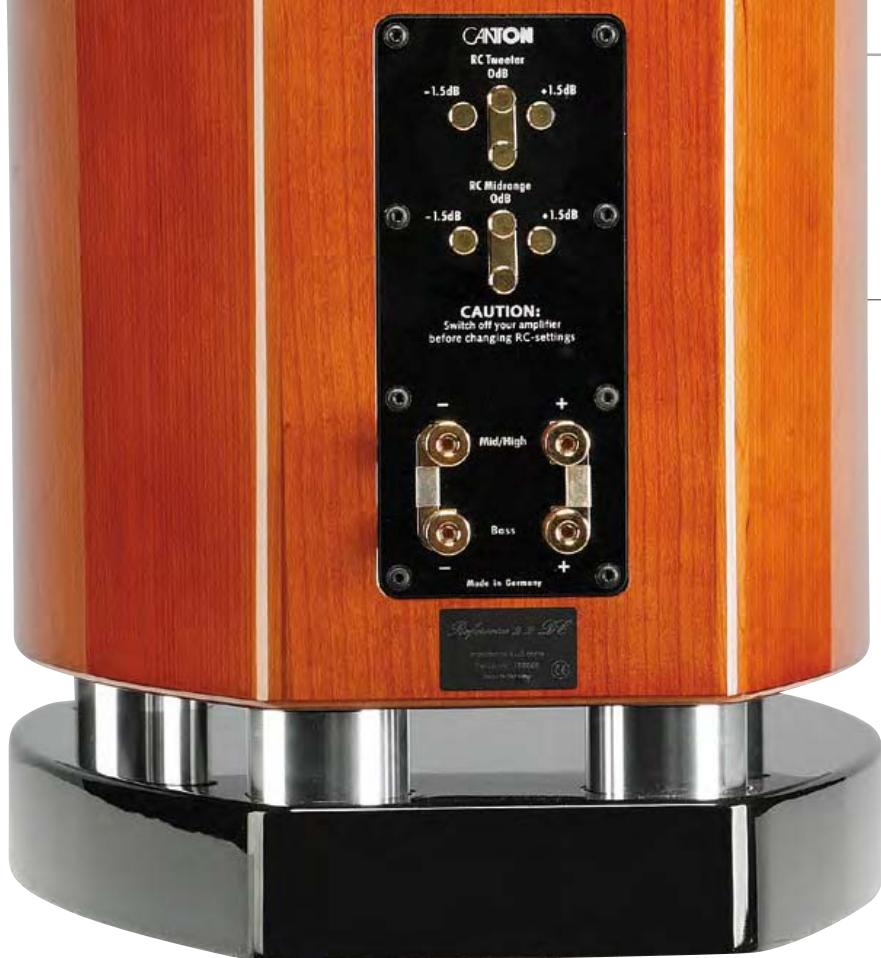
Pure Kontaktfreude: Hochwertige vergoldete Schraubklemmen fassen auch große Kabelquerschnitte. Der Frequenzverlauf lässt sich anpassen: Einfach die Brücken auf die entsprechend beschriftete Position stecken, schon werden Mittel- oder Hochtönen um 1,5 Dezibel angehoben oder abgesenkt.
