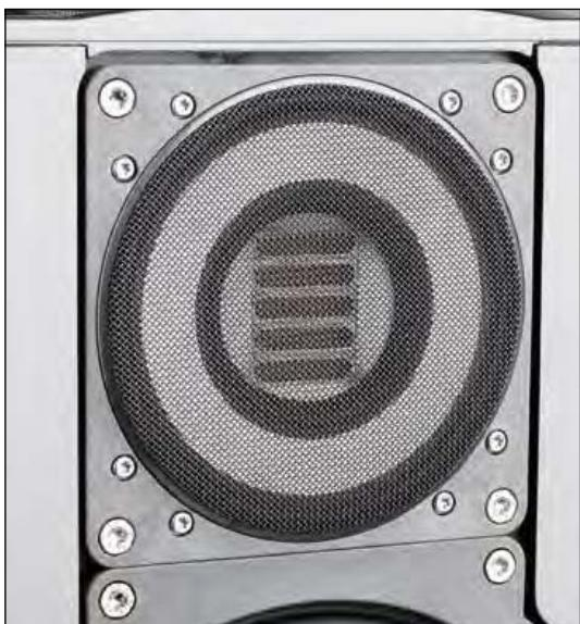
Koaxialtechnik à la Elac: Ein Flachmembran-Ringstrahler umgibt den Jet-Hochtöner in der Mitte – an den Schlitzten gut zu erkennen
