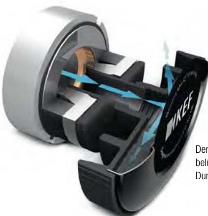
Der Hochtöner des Uni-Q-Chassis ist nach hinten belüftet. Seine Aluminiumkalotte mit 2,5 Zentimeter Durchmesser sitzt hinter einer akustischen Linse
