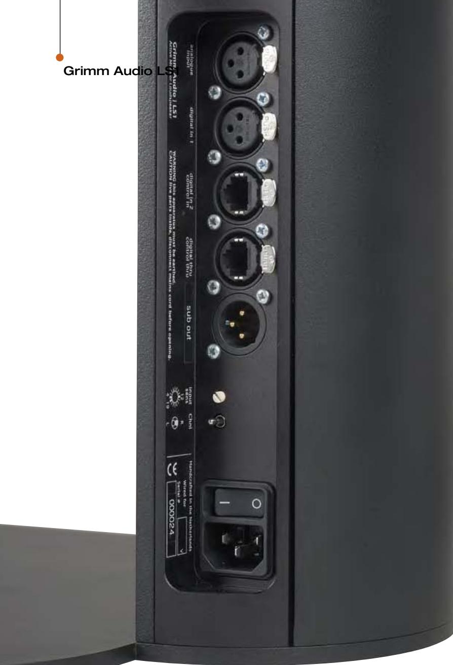
Per AES-Buchse geht's digital in die Box. Ein Adapterkabel auf S/PDIF liegt bei. Die MIDI-Buchsen dienen sowohl zum Anschluss der optionalen Fernbedienung „LS1 remote“ wie zur Verbindung mit der Studioelektronik
