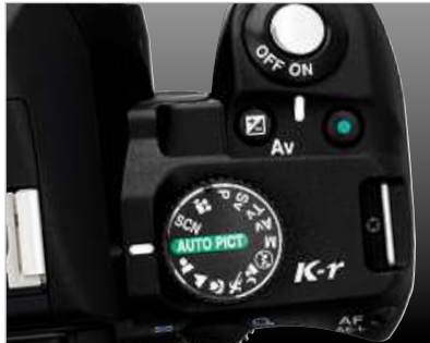
Die grüne Taste lässt sich frei mit einer Funktion belegen, wobei der Fotograf aus einer Vielzahl an Möglichkeiten wählen kann.
