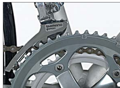
Ein Doppelkettenblatt erweitert den Alfine-Übersetzungsbereich auf über 400 Prozent.
