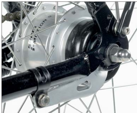
Typisch Rücktritt: Der Hebel an der Kettenstrebe dient als Widerlager zur Brems-Abstützung.
