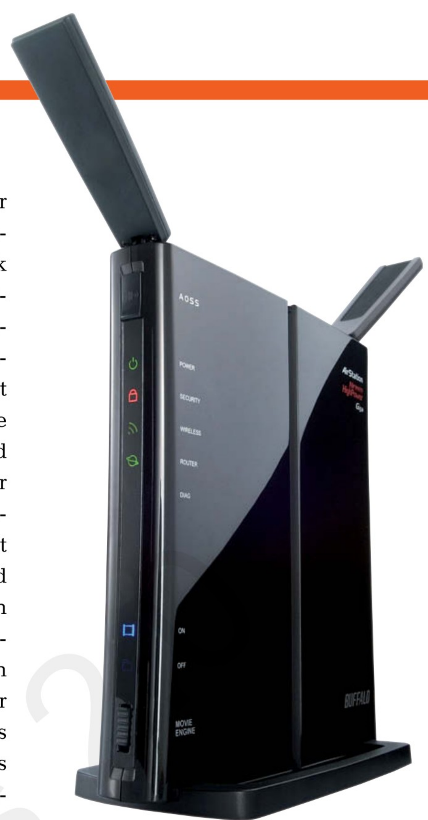
Buffalo WZR-HP-G300NH: Der Router glänzt mit hohen Datenraten und vier Gigabit-LAN-Ports (Bild B)
