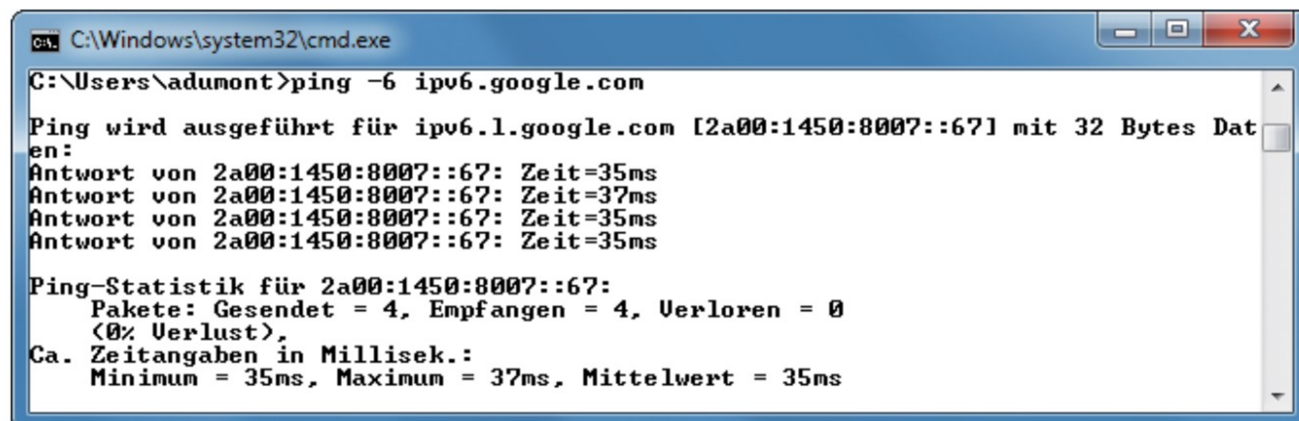
Ping: Das Tool prüft, wie lange es dauert, bis andere Geräte im Netzwerk eine Antwort liefern, und ist bereits IPv6-tauglich. Die IPv6-Adresse von ipv6.google.com lautet etwa 2a00:1450:8007::67 (Bild F)
