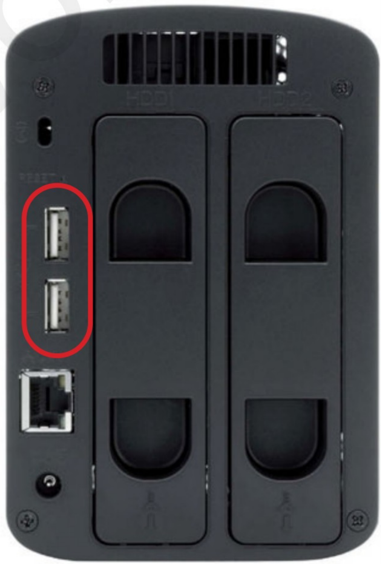
Andocken: Zumindest eine USB-Schnittstelle sollte das NAS aufweisen, damit Sie weitere Festplatten und Drucker anschließen können (Bild B)
