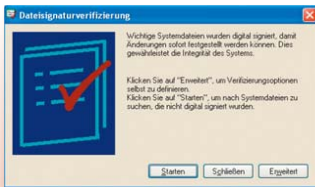
Verstecktes System-Tool: Das Bordwerkzeug Sigverif.exe ermittelt alle Treiberdateien, die nicht digital signiert sind (Punkt 9)
