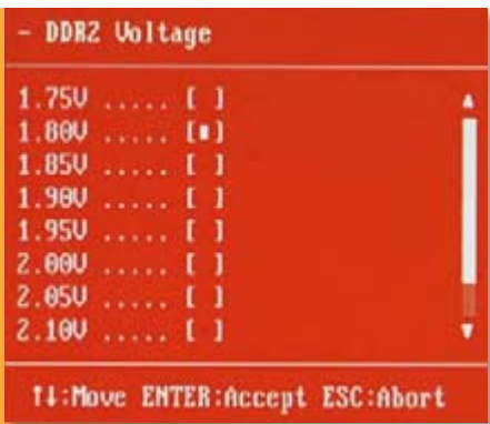
Mehr Stabilität beim Speicher-Tuning: „Voltage“-Option für eine höhere RAM-Spannung
