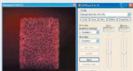
Grafikleistung verbessern: Nach einem Klick auf „Find Max Core“ und „Find Max Mem“ ermittelt ATI-Tool automatisch die optimalen Einstellungen
