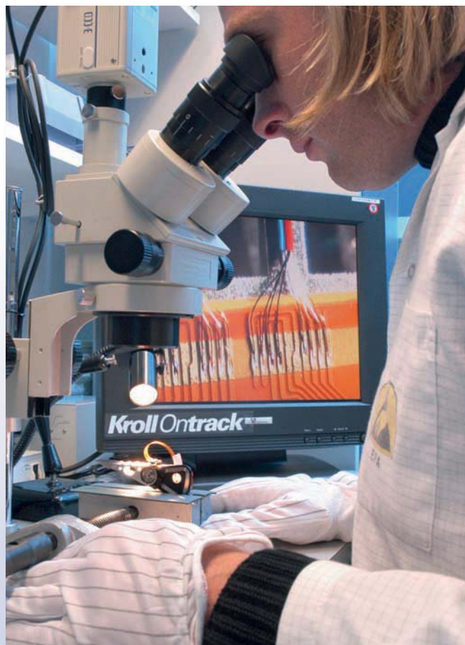
Erste Kontrolle: Die Verbindungen zwischen Schreib-Lese-Köpfen und Preamp (Vorverstärker) werden auf Kontakt überprüft
