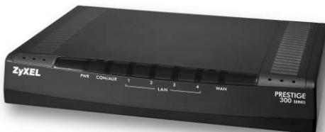
**3x Zyxel Prestige 324:** DSL-Router, Vierfach-Switch und Firewall in einem für ADSL. Beherrscht unter anderem DoS-Abwehr und Stateful Packet Inspection. Wert pro Gerät: rund 90 Euro.
