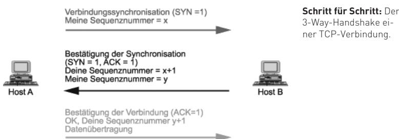
Befindet sich das System im Listen-Modus, wartet es auf ankommende Syn-Zeichen, um nach dem Eintreffen mit einem weiteren Syn-Zeichen zu antworten und in den „Syn Received“-Modus zu gehen. Wurde ein Syn-Zeichen gesendet, wechselt die Verbindung in den „Syn Send“-Modus. In diesem Modus bleibt das TCP-System, bis es vom Partnersystem als Antwort ein Syn-Zeichen erhält.
