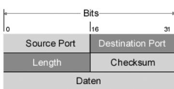
**Minimale Protokollmechanismen:** der UDP-Header im Detail.
