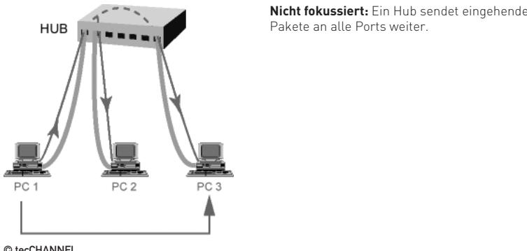
Da ein Repeater alle elektrischen Signale weiterleitet – also auch Kollisionen – gehören alle daran angeschlossenen Stationen zu einer Collision Domain. Zwar lassen sich mehrere Hubs kaskadieren, um größere Entfernungen zu überbrücken oder mehr Stationen anzuschließen, aber es müssen auf jeden Fall die Verzögerungszeiten (siehe Kollisionen) beachtet werden.
