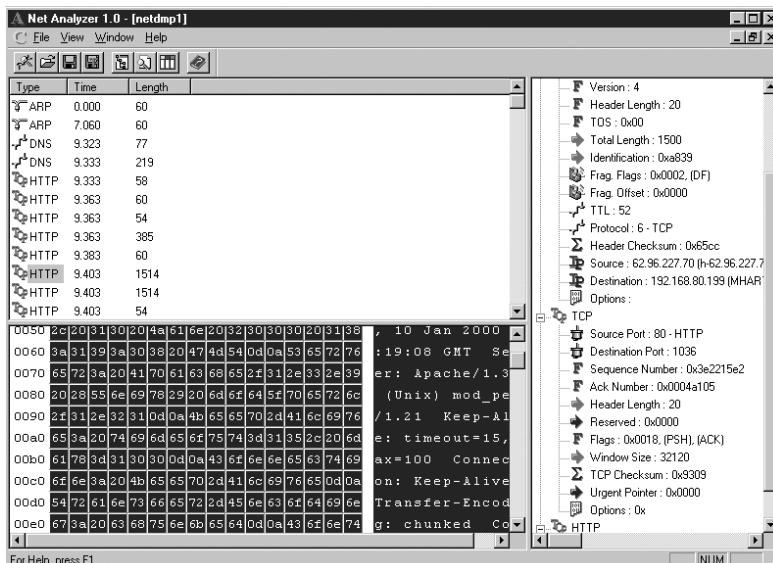
**Überwachung leicht gemacht:** Der PackAnalyzer protokolliert ein- und ausgehende Netzwerk-pakete und stellt sie übersichtlich dar.
