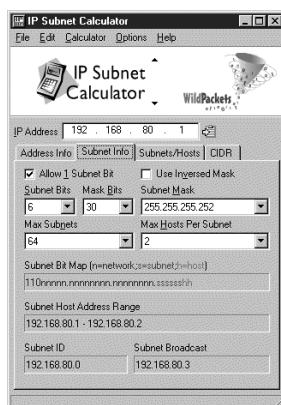
**Netzwerkadministration leicht gemacht:** Der IP Subnet Calculator hilft bei der Berechnung der möglichen Subnetzbereiche.
