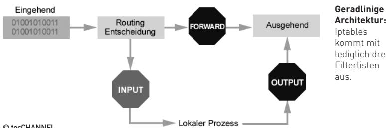
Geht ein Paket an der Netzwerkschnittstelle ein, wertet der Kernel zunächst dessen Zieladresse aus (Routing-Entscheidung). Ist das Paket für den lokalen Rechner bestimmt, reicht er es an die INPUT-Kette weiter. Falls nicht, entscheidet die Forwarding-Konfiguration über das weitere Schicksal des Pakets. Bei aktivem Forwarding übernimmt die FORWARD-Kette die Weiterverarbeitung, andernfalls wird das Paket verworfen.
