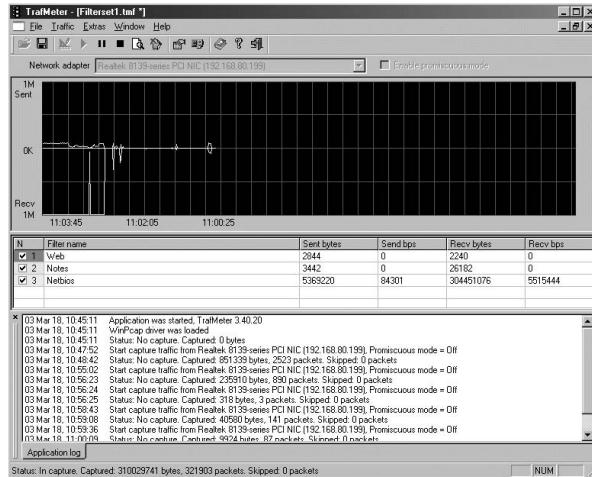
Der Traffic wird zum einen in einem mehrfarbigen Graphen dargestellt und zum anderen in eine XML-Datei gespeichert, so dass eine Auswertung per automatisierter Tools problemlos möglich ist.
