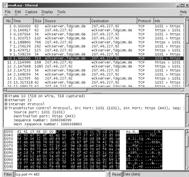
Mit der leistungsfähigen Kombination der Tools Ethereal ([www.ethereal.com](http://www.ethereal.com)) und WinPcap (<http://netgroup-serv.polito.it/winpcap/news.htm>) behalten Sie selbst den Überblick darüber, welche Datenpakete ein Programm ins Internet verschickt. Über Filter können Sie festlegen, welche Art von Paketen von den Tools analysiert werden soll.
