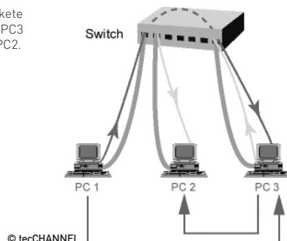
Letztlich erzeugt also jeder Switch-Port eine eigene Collision Domain. In dieser Hinsicht zählt der Switch-Port als Endgerät. Bei der Berechnung der Verzögerungszeit braucht man also lediglich die Bitzeiten zwischen der Station und dem Switch aufzusummen.
