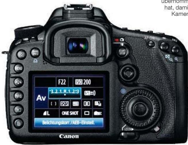
ren an Tempo mobilisieren können, zeigt sich dann bei Serienbildern: 7,5 B/s bei maximaler Bildauflösung sind für eine 18-Megapixel-APS-C-Kamera ziemlich gut. Das Belichtungsmesssystem berücksichtigt neben Helligkeit und Objektfarbe auch die Entfernung zum Motiv.
