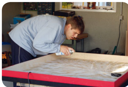
2 Nachdem alle 180 Glasfasern in die zugehörigen Löcher (je 1 mm Durchmesser) gesteckt wurden, werden sie mit einfachem Sprühkleber fixiert.
