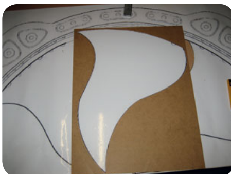
5 Die ausgeschnittenen Schablonen werden auf vorbereitete Holzteile übertragen und anschließend mit einer Stichsäge ausgeschnitten.
