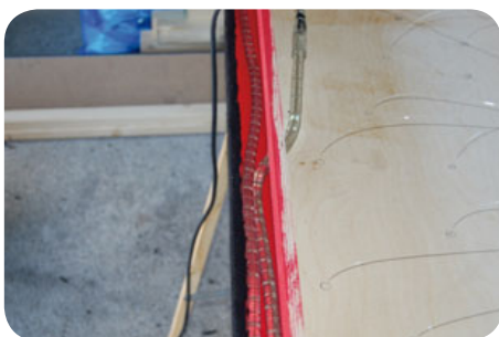
1 Nahaufnahme: Der rote Lichtschlauch liegt gleich neben dem Befestigungsrahmen und sorgt von hier für eine angenehme Hintergrundbeleuchtung.
