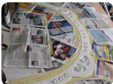
10 Später soll die Vorrichtung in vier verschiedenen Farben glänzen. Deshalb müssen Teile der Konstruktion immer wieder abgeklebt werden.
