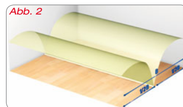
Auch in der Breite (und Raumhöhe) entstehen stehende Wellen, deren Frequenzen von der Raumbreite abhängen. Auch hier existieren „laute“ und „leise“ Stellen, allerdings bei anderen Frequenzen, sofern der Raum nicht quadratisch ist
