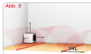
Abb. 5 Steht der Subwoofer direkt im Maximum einer stehenden Welle, wird diese stark angeregt. Der Schalldruckverlauf dieser Frequenz im Raum wird durch die rote Fläche symbolisiert
