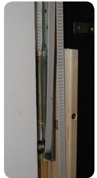
Die Führung der Maskierung geschieht über einfache Rollladenbänder. Diese sind mit massiven Metallfedern bestückt, die die Bänder stets auf Spannung halten
