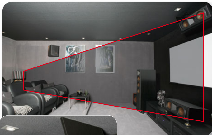
Perfekt gelöst: Beide Center sind im Idealwinkel auf die Referenzposition ausgerichtet. Während die untere Box mittels Pucks angewinkelt wurde, entstand für den oberen Center eine passgenaue, an der Decke montierte Holzbehausung
