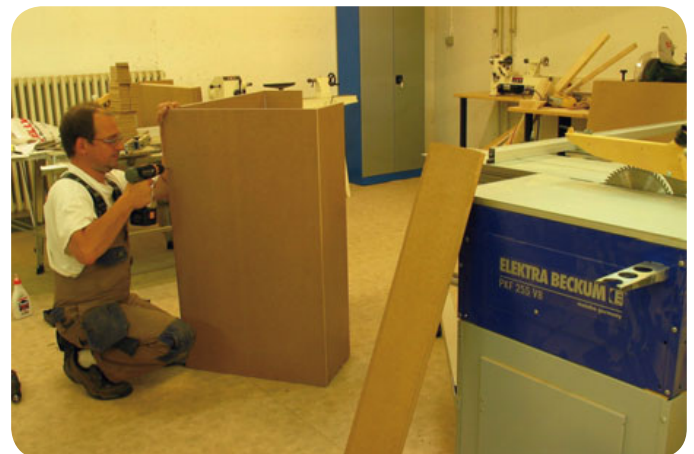
2 Exakt nach dem ausführlichen Plan von Jochen Veith wurden rund 100 Quadratmeter MDF-Platten zu voluminösen Tiefton- und Breitbandabsorbern verarbeitet. Dank eigener Holzwerkstatt und passendem Know-how konnte alles in Eigenleistung erledigt werden.
