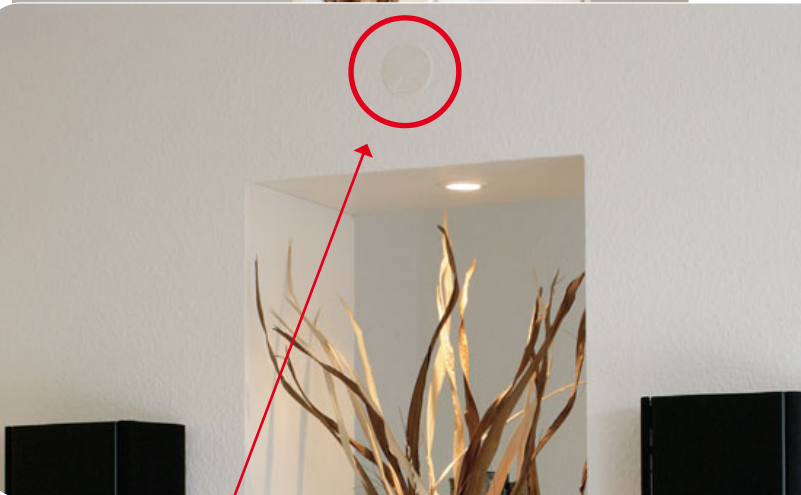
Entnimmt man den weißen Kabelausslass, ist die Linse des in der Wand befindlichen Benq-Beamers deutlich sichtbar
