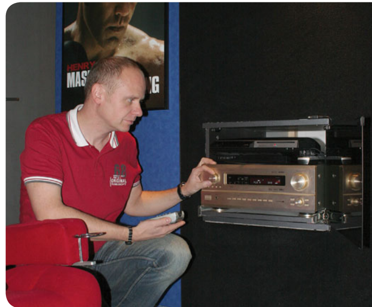
Clever: Verstärker und Zuspeler wurden einfach in die Wand eingelassen und ruhen dort auf einem Schubladenauszug, der sich nahezu vollständig ausfahren lässt. So kommt Thomas F. mühelos an alle Anschlusskabel
