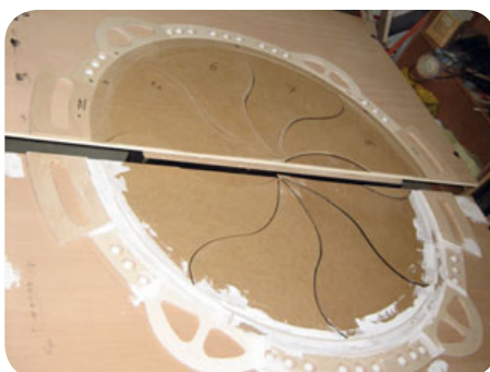
8 Es geht vorwärts: Die komplette Iris ist auf den Schiebeelementen befestigt. Wichtig ist, dass die geschwungenen Teile sich leicht überlappen.
