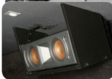
Perfekt gelöst: Beide Center sind im Idealwinkel auf die Referenzposition ausgerichtet. Während die untere Box mittels Pucks angewinkelt wurde, entstand für den oberen Center eine passgenaue, an der Decke montierte Holzbehausung
