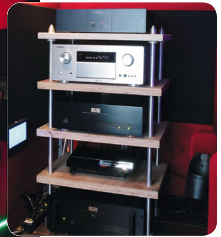
Das massive Hardware-Regal entstand im Eigenbau. Es besteht aus 40 Millimeter starken Holzböden, welche aus einer nicht mehr benötigten Werkbank gesägt und anschließend geschliffen wurden. Getragen werden diese von massiven Gewindestangen, die die millimetergenaue Höheneinstellung jeder einzelnen Ebene erlauben. Einige der hier abgebildeten Geräte wurden inzwischen übrigens gegen neuere Modelle ausgetauscht
