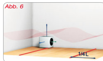
Abb. 6 Verschiebt man den Subwoofer an die Stelle eines Schalldruckminimums, kann die stehende Welle nur sehr schwach angeregt werden. Eine deutlich schwächere Ausprägung von „lauten“ und „leisen“ Stellen im Raum bei dieser Frequenz ist die Folge, die Basswiedergabe ist deutlich ausgewogener
