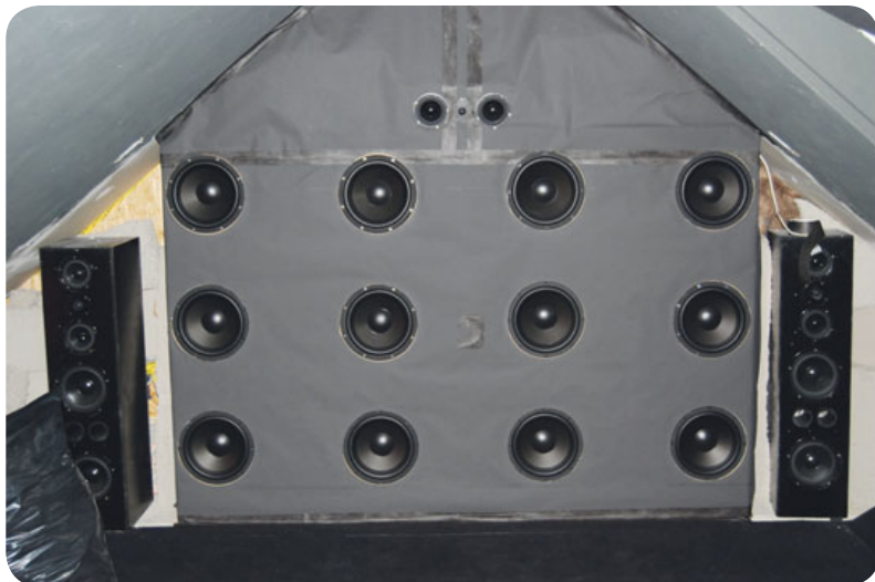
Front-Power: Nachdem Fuat R. die verschiedensten Arten der Subwoofer-Anordnung ausprobiert hatte, stellte sich die Frontaufstellung als Ideallösung für sein Heimkino heraus. Alle zwölf Bassisten befinden sich hinter der akustisch transparenten Leinwand und sorgen von hier für ein Bassvergnügen, wie man es wohl nur in den wenigsten privaten Lichtspielhäusern Europas erleben darf
