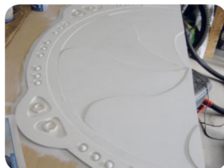
9 Das sieht doch schon gut aus: Die erste Schiebetür ist grundiert und für die Lackierung vorbereitet.
