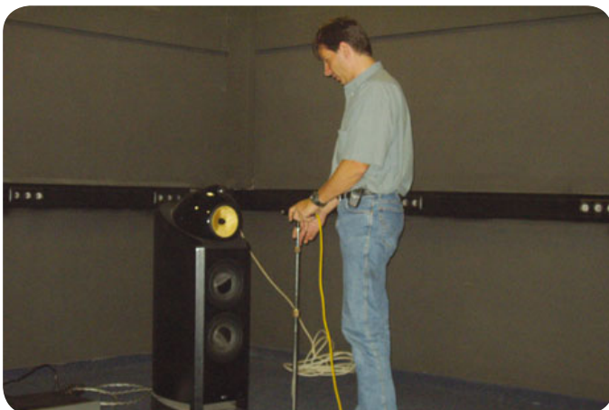
1 Der erste Schritt: Akustikprofi Jochen Veith ermittelt die akustischen Raumparameter anhand ausführlicher Messungen im komplett leerraumten 60-qm-Hörraum.
