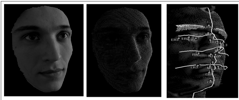
3D-Analyse: Aus einem 3D-Gesichts-Scan erzeugt das System Vektorpunkte, die zur Identifikation der erfassten Person benutzt werden. (Quelle: Unisys)
