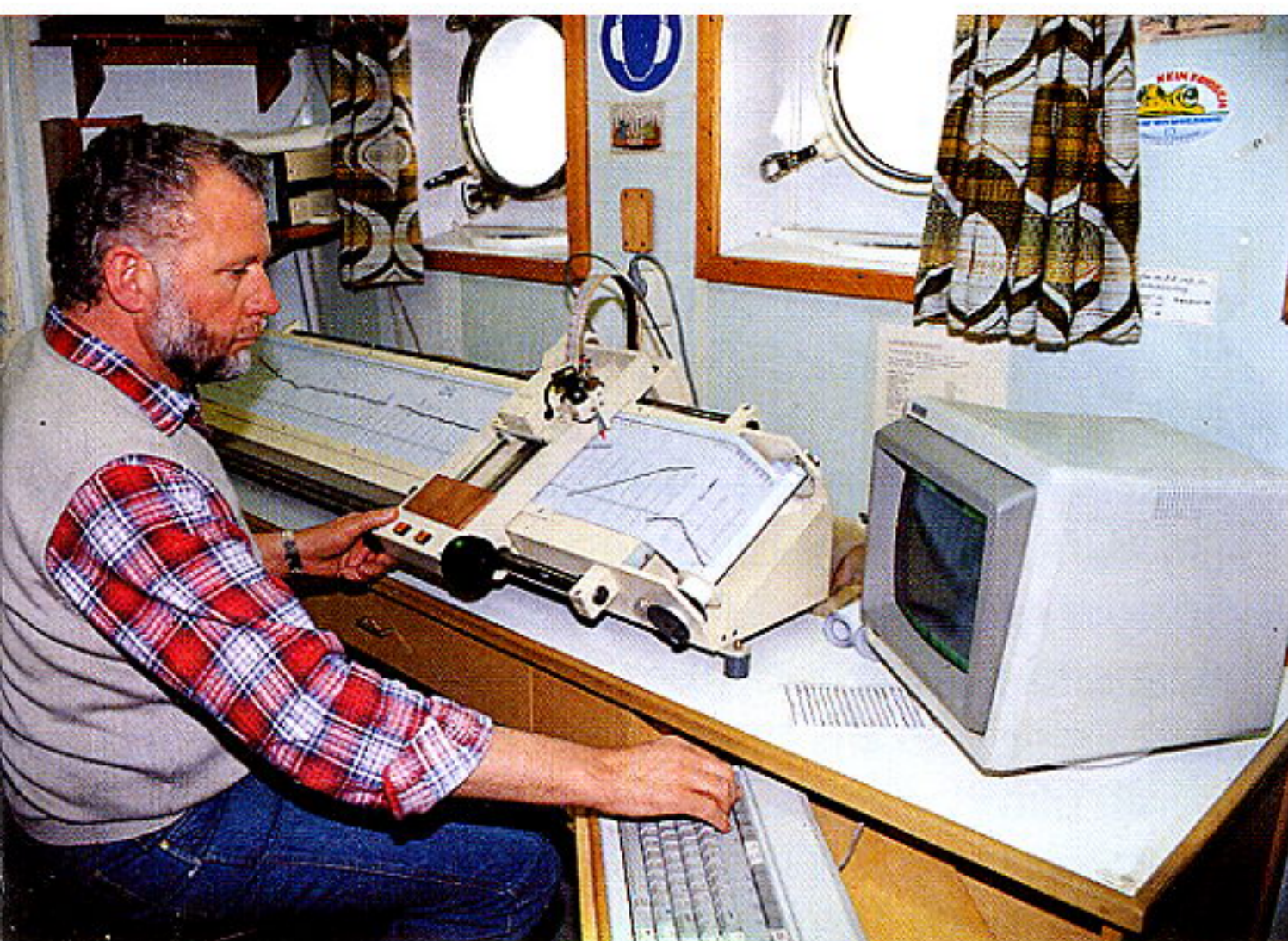
Ein Techniker überwacht am Bandschreiber die computergesteuerte Auswertung der vom Meeresboden zurückgeworfenen Signale.
