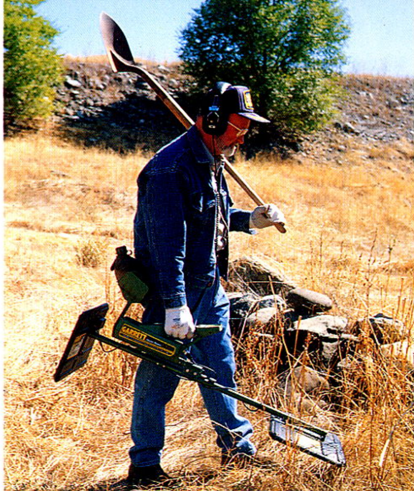
Feldarbeit mit einem Detektor, der mit Tiefortungs-sonden ausgestattet ist. Damit können Metalle auch in größerer Tiefe entdeckt werden.
