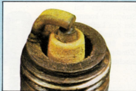
1. Normales Aussehen mit richtigem Wärmewert in einwandfreiem Motor.
