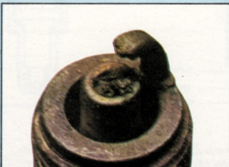
6. Verkürzte Masse- und Mittelelektroden durch Frühzündungen.
