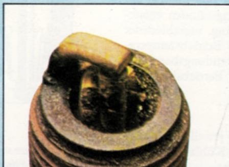
7. Gespaltener Isolatorfuß, wahrscheinlich durch Explosionsschwingungen.
