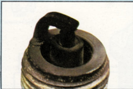
3. Samtartiger Rußbelag durch zu fettes Gemisch und zu großen Elektrodenabstand.
