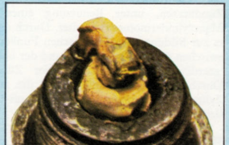
2. Starker Belag, der durch Brennstoff- oder Ölzusätze entstanden sein kann.
