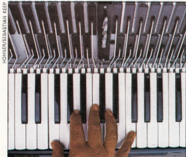
Oben: Die Tastatur der Melodie-Seite einer Tango-Harmonika. Jede Taste ist auf der Gehäuseseite beweglich gelagert und an einem Metallarm befestigt. Durch Tastendruck bewegt sich der Hebelarm mit der Ventilabdeckung nach außen.
