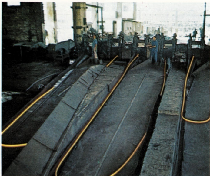
Links: Warmziehen in einer Drahtzieherei in Pakistan.
