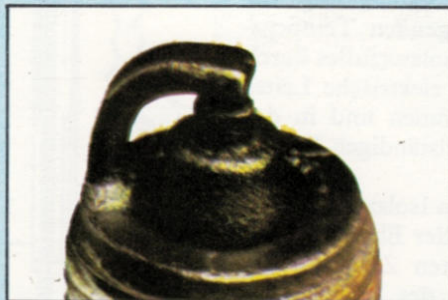
4. Belag von feuchter Ölkohle und Ruß durch zu viel Öl im Verbrennungsraum.
