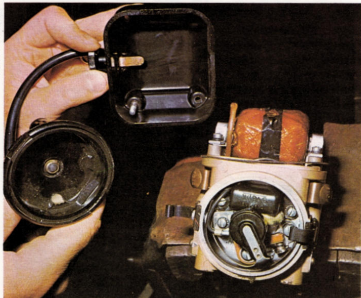
Oben: Blick auf die Unterseite eines Magnetzünders mit den Unterbrecherkontakten und dem Kondensator.
