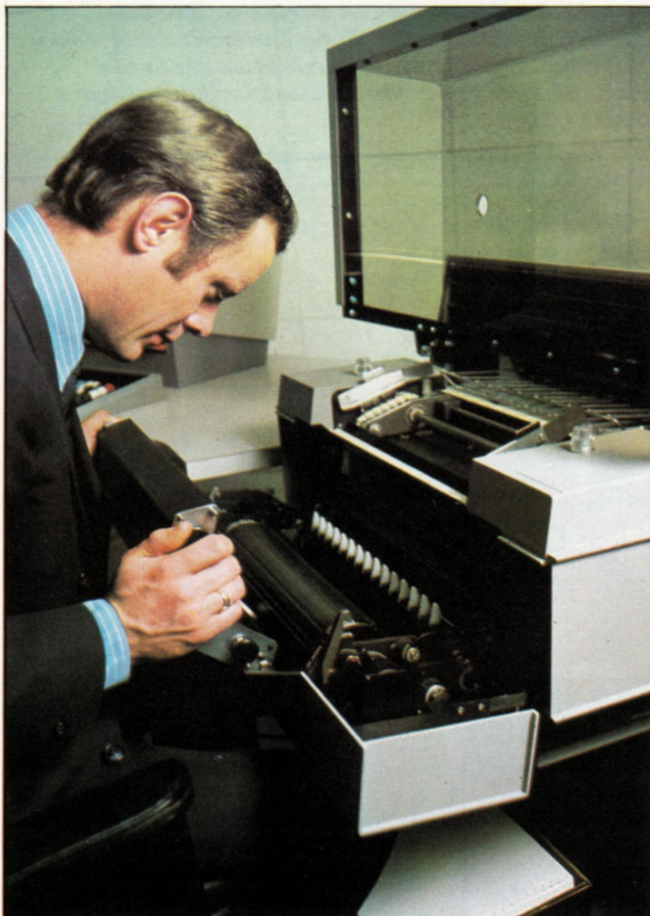
Im Gegensatz zum Farbband einer Schreibmaschine, das sich horizontal bewegt, läuft das Farbband eines Zeilendruckers vertikal; es ist so breit, daß es die ganze Zeile bedeckt.
