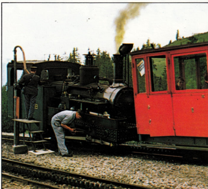
Die Schweizer Rothornbahn (System Abt). In Haltestellung ist die Neigung flacher, so daß der auf stärker geneigter Strecke waagrecht stehende Kessel hier einen leichten Winkel bildet.
