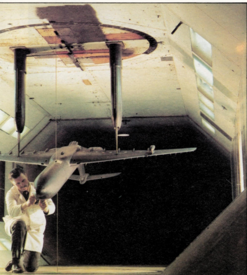
Oben: Techniker bei der Vorbereitung eines genau maßstabgerechten Modellflugzeuges zum Windkanaltest. Konstruktionsfehler lassen sich dadurch im voraus ausgleichen.
