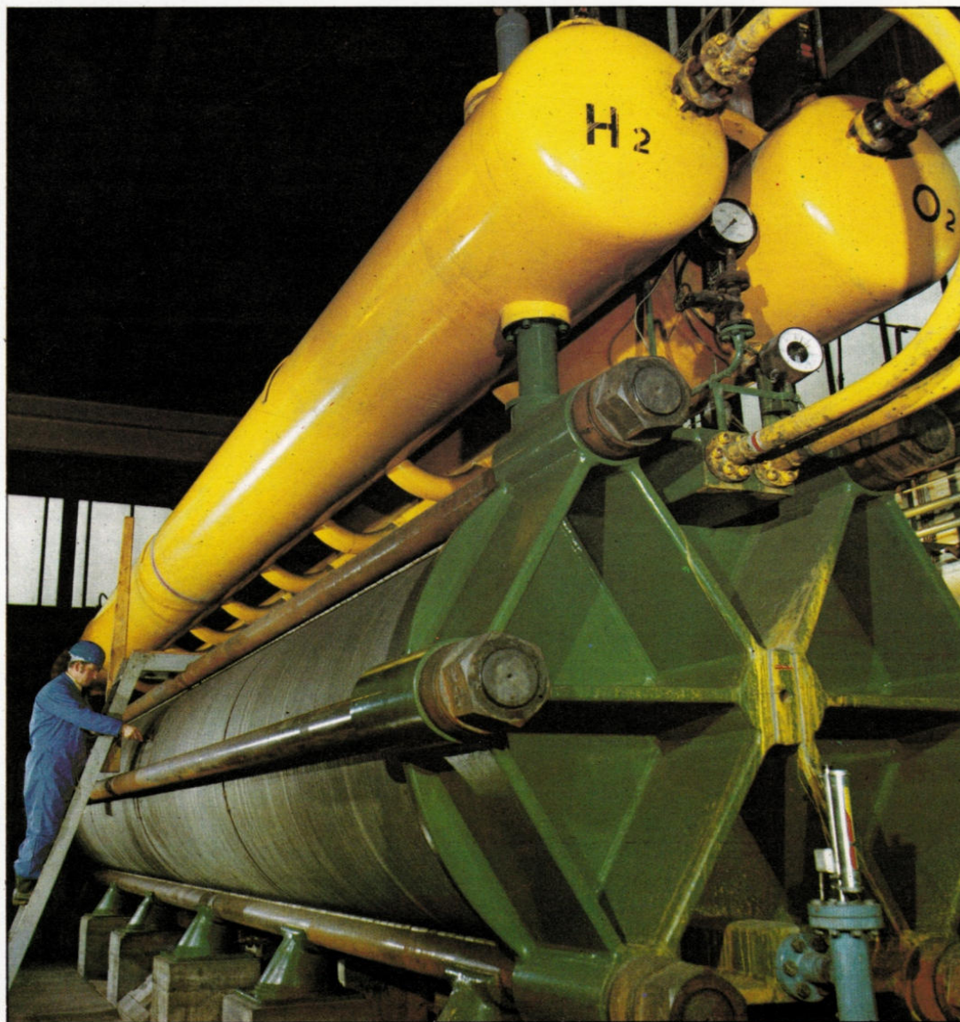
Rechts: Ein Elektrolysegerät. Der Wasserstoff wird aus Wasser gewonnen. Das Gerät besteht aus 100 bis 556 engen Druckzellen, die alle eine Katode und Anode haben und durch ein Diaphragma abgeteilt werden. Der Elektrolyt (Ätzkali) wird zusammen mit dem Wasser von unten eingepumpt. Die entstandenen Gase bilden ein Emulsionsgemisch mit dem Elektrolyten. Sie werden über getrennte Kanäle den beiden oberen Rohren zugeführt. Die Gase werden hier vom Elektrolyten, der wiederverwendet wird, getrennt.
