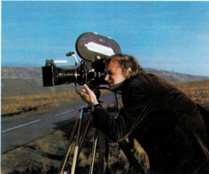
16-mm-Kamera mit Zoom-Objektiv für Dokumentar- oder Fernsehfilme. Trotz 10fachen Zoombereichs ist diese Ausführung besonders kompakt. Die Variooptik kann entweder von Hand oder mit Hilfe eines Elektromotors betätigt werden.
