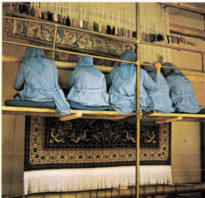
Oben: Teppichweber im Iran. Bei diesem Teppichtyp muß ein Florfaden von Hand in jeden Kettfaden eingeknüpft werden. Anschließend wird der Schußfaden pro Knotenreihe 2- oder 3mal hindurchgeschossen.
