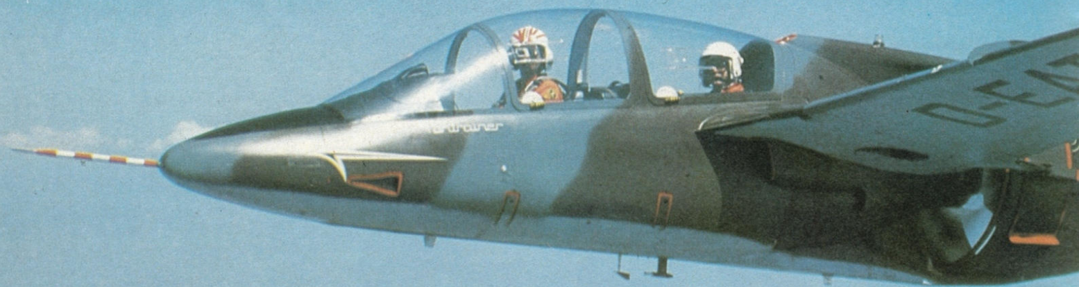
Der 'Fantrainer', von Rhein-Flugzeugbau (VFW) entwickelt, wird jetzt von einem 295 kW Turboprop-Triebwerk angetrieben —der erste Prototyp jedoch war mit zwei gekoppelten Wankeltriebwerken von je 110 kW ausgerüstet.
