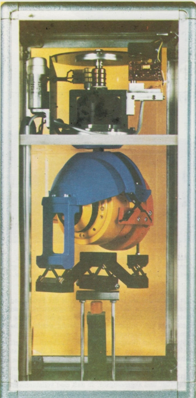
Der Kreisel dieser elektronischen Waage vollführt durch Kraft-einwirkung eine Präzisionsbewegung, deren Geschwindigkeit der angelegten Kraft proportional ist und so gemessen werden kann.
