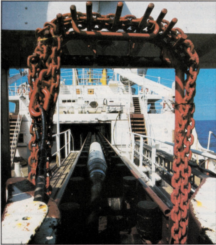
Oben: Der zylindrische Gegenstand in der Mitte des Bildes ist ein Verstärker, der für besseren Empfang von durch Unterwasserkabel geleiteten Telefonsignalen sorgt.
