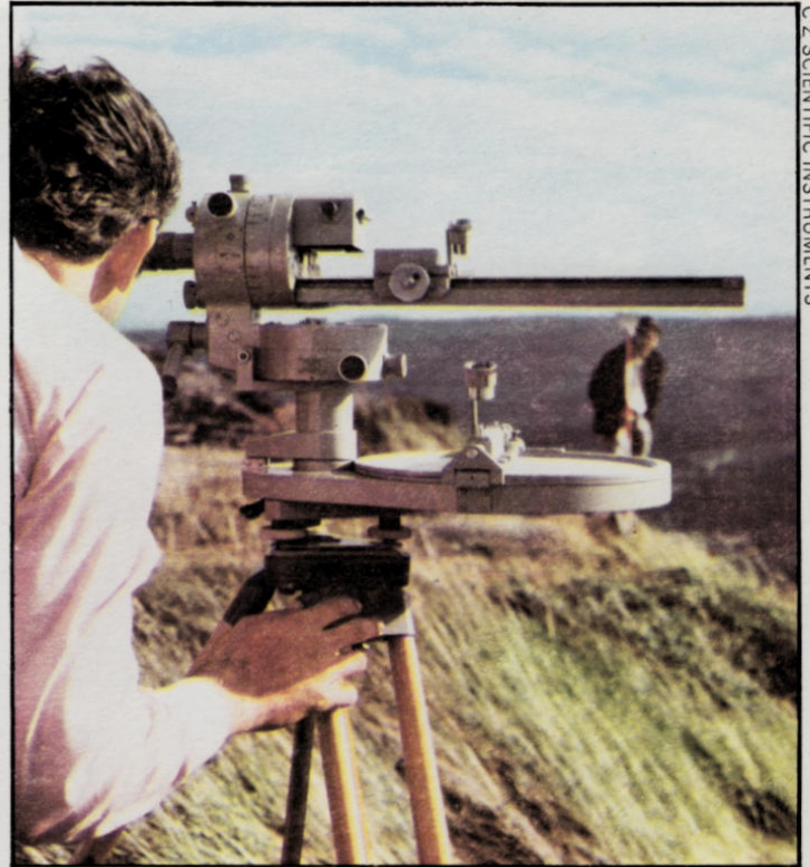
Reduktions-Entfernungsmesser zur Messung von horizontalen Entfernungen.
