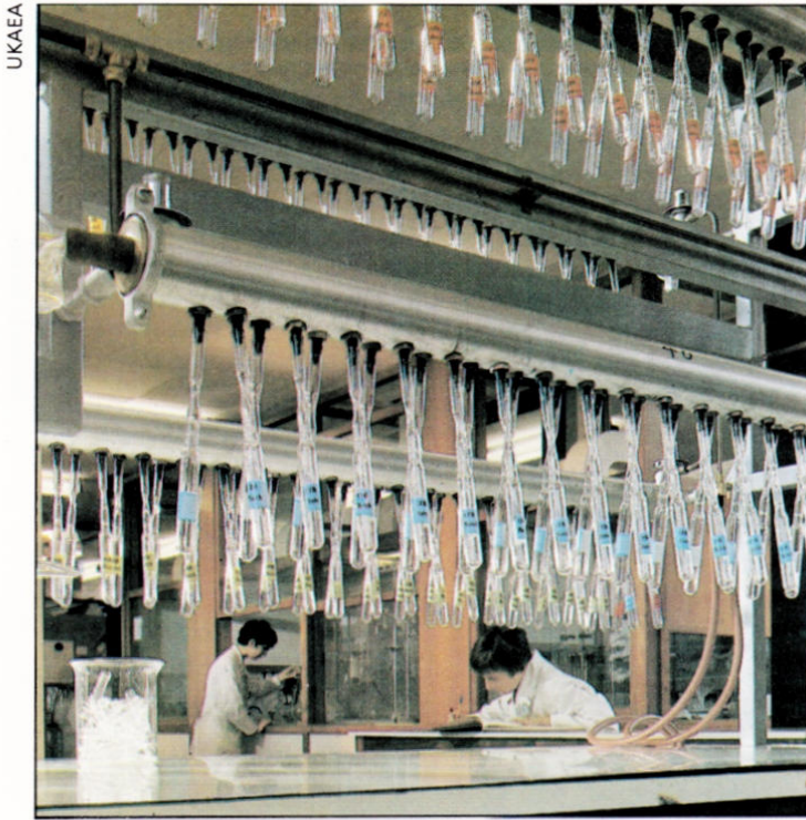
Abdichten eines Vakuums in einer Röhre. Diese Ampullen, die ein radioaktives Material enthalten, sind an einen Vakuumverteiler angeschlossen. Läßt man auf den Ampullenhals eine Flamme einwirken, erweicht das Glas; es wird zusammengedrückt und dichtet auf diese Weise ab.
