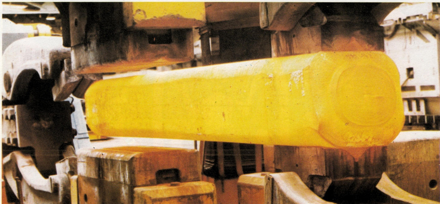
Oben: Ein großer Gußblock aus Titan, der in einer 1800-Tonnen-Schmiedepresse geschmiedet wird. Titan wird außer in der Flugzeugindustrie auch in der Farbenindustrie verwendet, und zwar in seiner Oxidverbindung \text{TiO}_2 .
