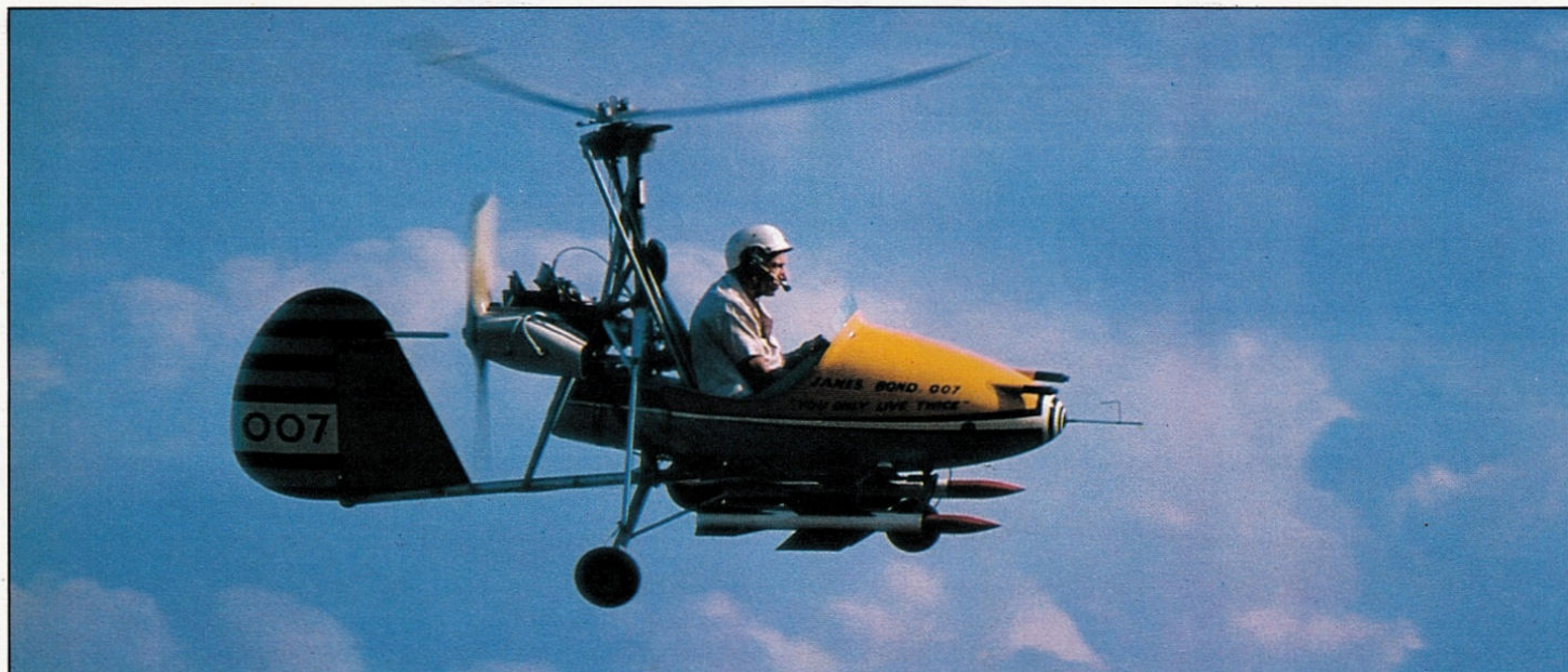
Oben: Ein sich im Flug befindlicher Tragschrauber. Der Vorwärtsantrieb erfolgt durch den hinteren Propeller.
