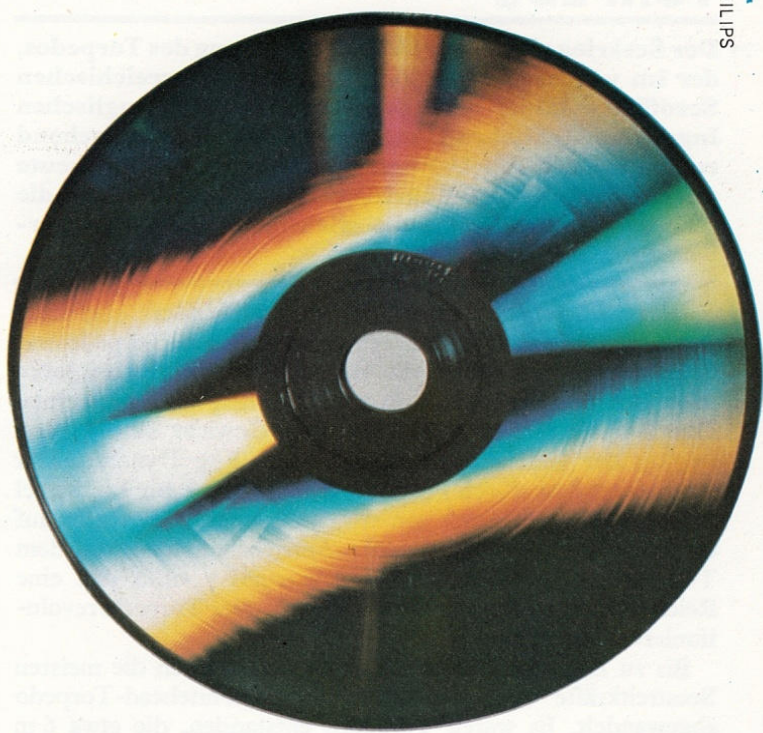
Oben: Die Philips VLP (= Video Long Player) Platte ist mit einer hochreflektiven Schicht bedeckt. Die Video- und Tonspursignale befinden sich verschlüsselt in dieser Schicht und werden je nach Reflexionskraft durch Laser aufgespiert.
