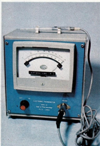
Unten: Widerstandsthermometer sind für Präzisionsmessungen gut geeignet. Dieses Thermometer, dessen Temperaturfühler oben gezeigt ist, umfaßt den Meßbereich von 30^{\circ}\text{C} bis 40^{\circ}\text{C} und kann selbst geringste Änderungen der Körpertemperatur registrieren.
