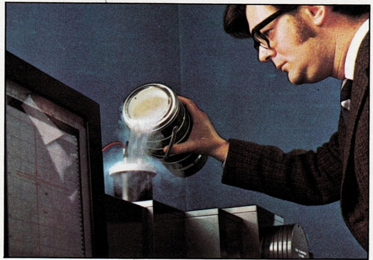
Oben: Aus einem Dewar-Gefäß wird flüssiger Stickstoff in einen Kryostaten gefüllt, in dem Substanzen bei tiefen Temperaturen untersucht werden können. Unten: Rechts eine vollständige Vakuumflasche und links daneben eine teilweise entmantelte Flasche, an der man den doppelwandigen Aufbau erkennen kann.
