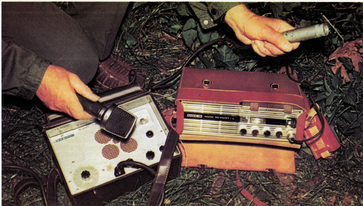
Mit diesem Tonbandgerät werden Fledermäuse aufgespürt. Die Einheit links fängt die unhörbaren Ultraschall-Geräusche auf, die von Fledermäusen ausgehen. Sie werden dann hörbar gemacht und aufs Tonbandgerät übertragen.
