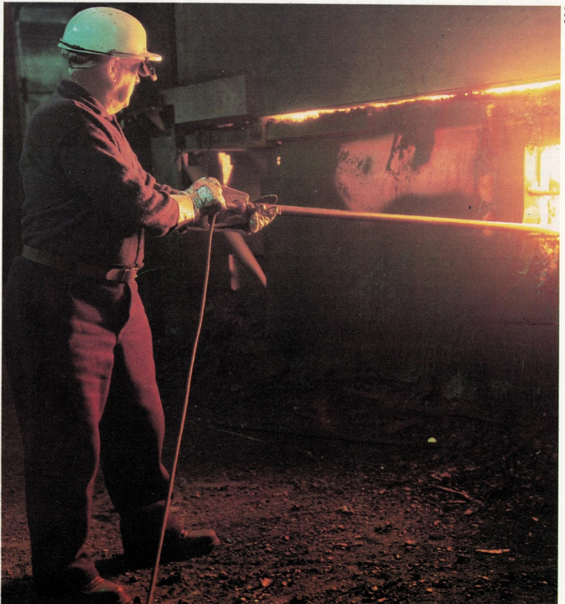
Rechts: Ein Pyrometer wird zur Messung der Temperatur in Stahlwerken benutzt.
