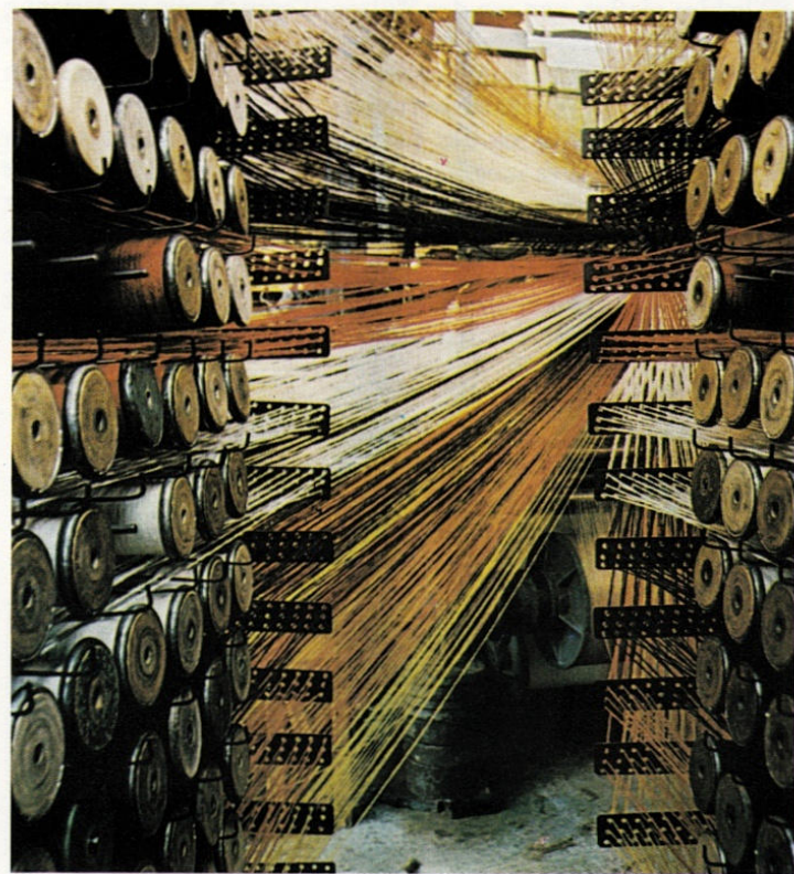
Oben: Blick auf die Maschinenrückseite. Die Fadenschar wird der Maschine von hinten zugeführt.
