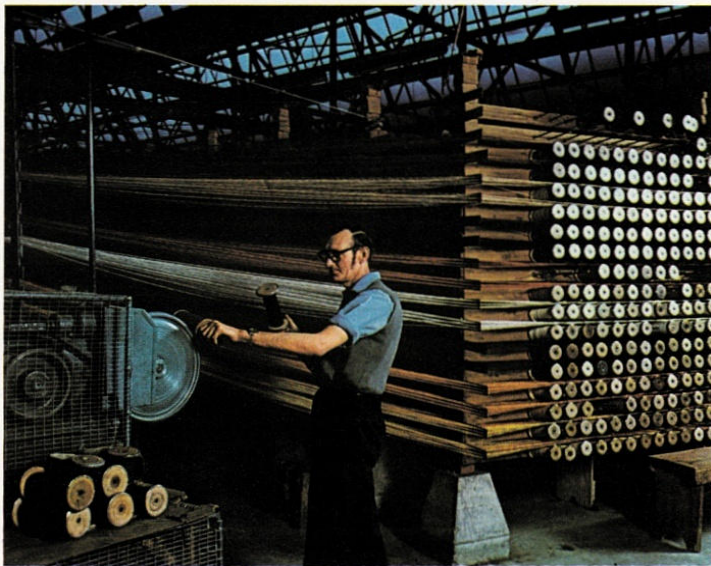
Oben: Hinter dem Webstuhl befindet sich ein Spulengatter, von dem aus das Florgarn den Fadenführern zugeführt wird, um schließlich von den Greifern abgezogen zu werden. Mit diesem System lassen sich bis zu 8 Farben verarbeiten.
