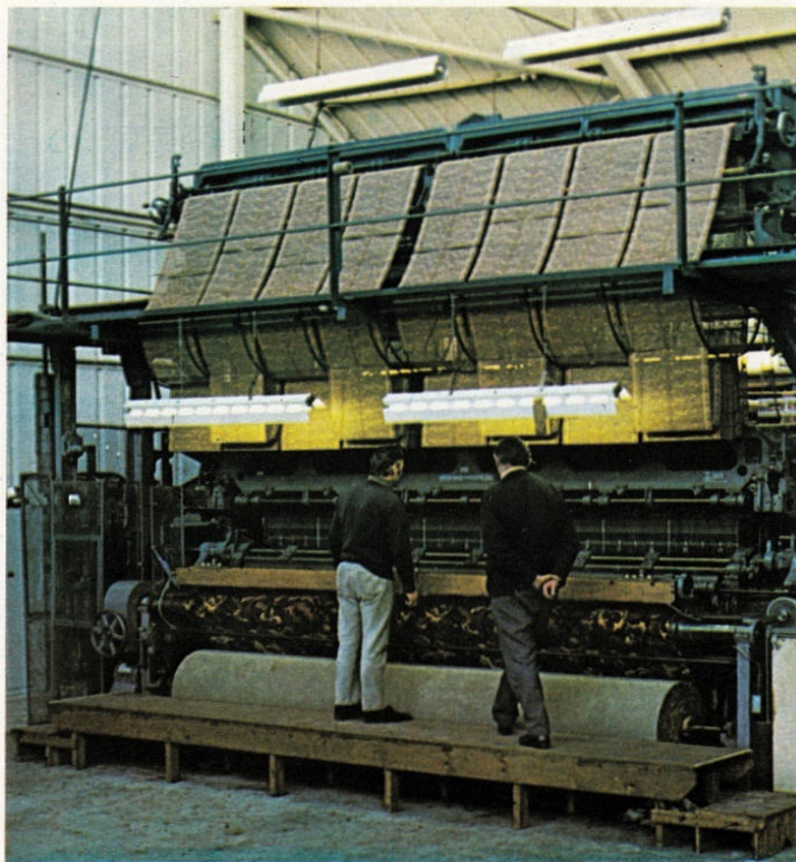
Oben: Gesamtansicht eines Axminster-Teppichwebstuhls. Oben erkennt man die Lochkarten für die Jacquardeinrichtung. Sie bestimmen das Muster, das durchaus sehr komplex sein kann, obwohl die Zahl der Farben auf 8 begrenzt ist.
