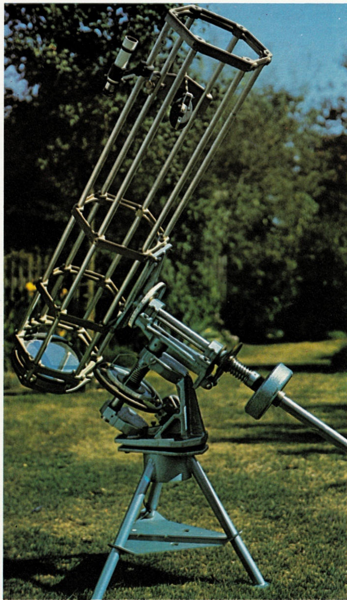
Oben: Ein Newtonsches Spiegelteleskop für den Hobby-Astronomen. Der Spiegel hat einen Durchmesser von 23 cm. Mit diesem Teleskop kann man z.B. Mondkrater erkennen.
