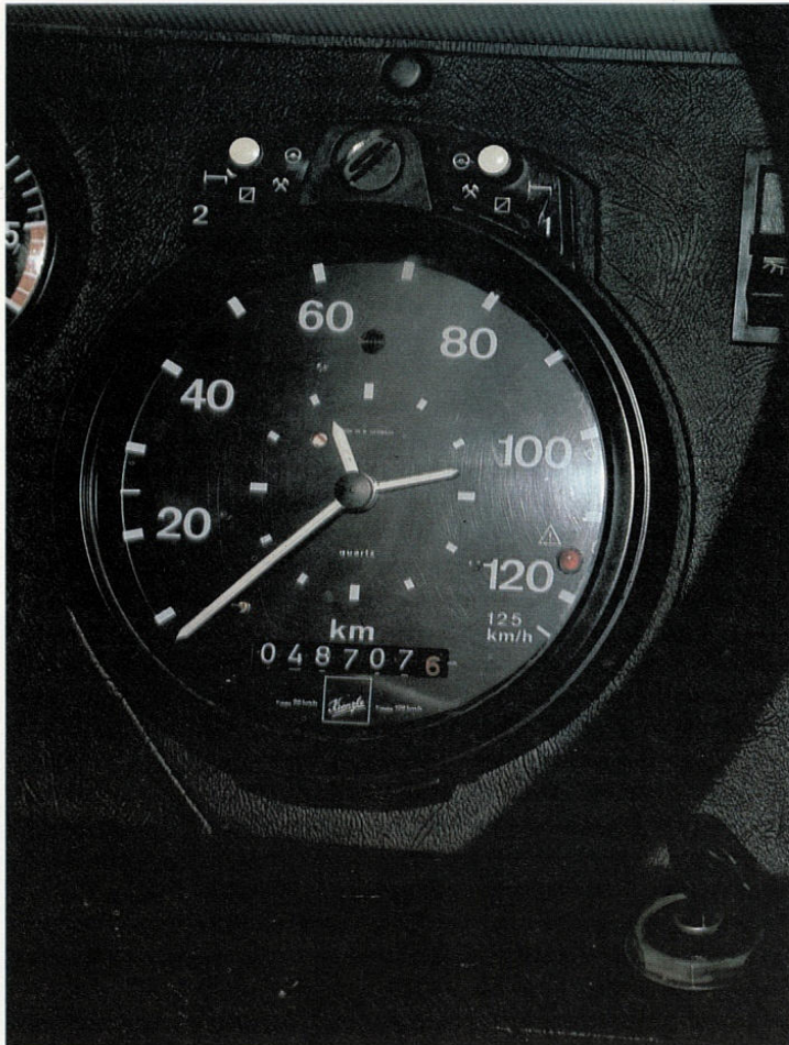
Oben: Ein Fahrtschreiber (Tachograph), wie er für LKWs in der Bundesrepublik Deutschland gesetzlich vorgeschrieben ist. Man kann auf dem abgebildeten Zifferblatt Uhrzeit, Geschwindigkeit und zurückgelegte Kilometerzahl ablesen.
