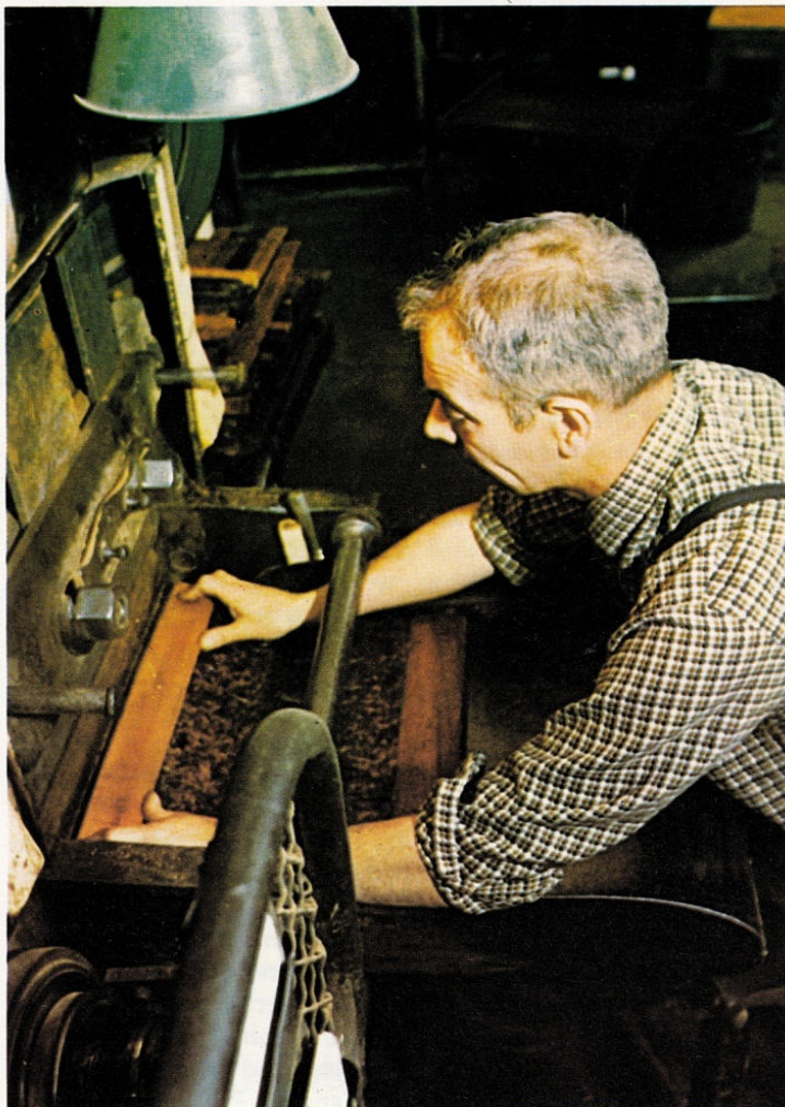
Unten: Das 'Spinnen' von Pfeifentabak in einer tabakverarbeitenden Fabrik. Nach diesem Prozeß wird das Erzeugnis 'Röllchentabak' genannt.
