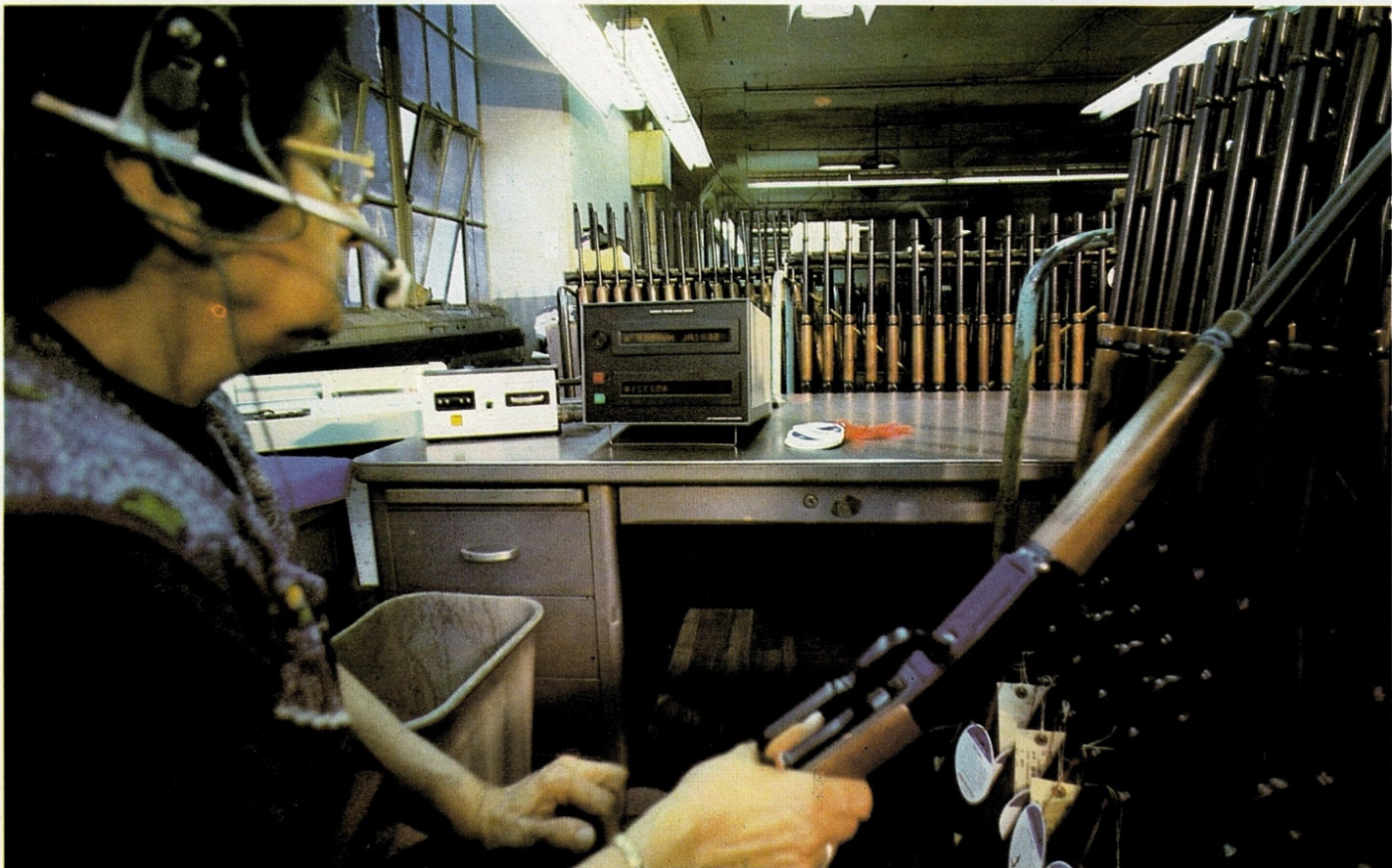
Unten: Die Nummern der Gewehre werden hier über eine Computeranlage, die die Angaben des Prüfers versteht, mit den Angaben in der Datenbank verglichen.
