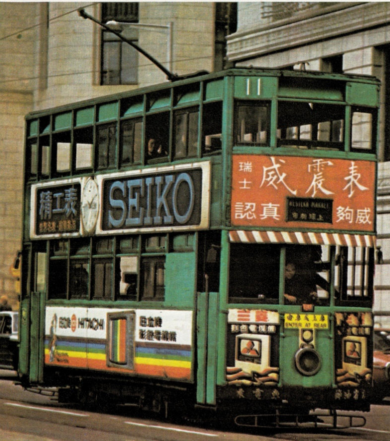
Oben: Eine Doppeldeck-Straßenbahn in Hongkong. Die elektrische Antriebskraft ist umweltfreundlich und ermöglicht einen geräuscharmen Fahrbetrieb. Aus diesem Grunde wird die Straßenbahn trotz ihres Nachteiles, nicht sehr gut manövrierbar zu sein, noch immer in vielen Großstädten eingesetzt.
