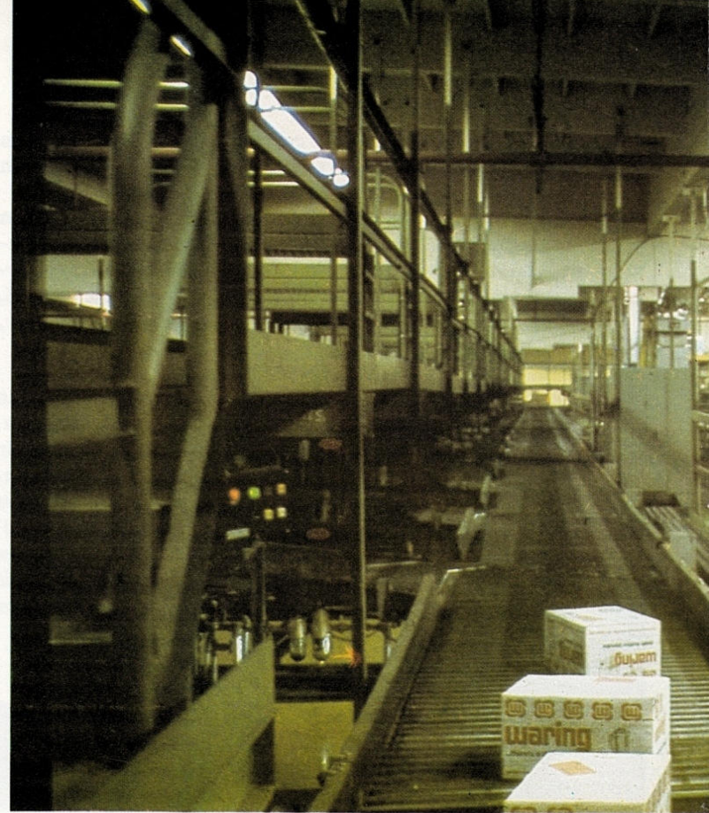
Oben: In einem Lagerhaus wird das automatische Verteilungssystem für mehrere gleichzeitig zu verteilende Lebensmittellieferungen über einen Computer gesteuert. Der Computer verteilt die Pakete auf verbal gegebene Anordnung des Kontrolleurs, die der Computer erkennen kann.
