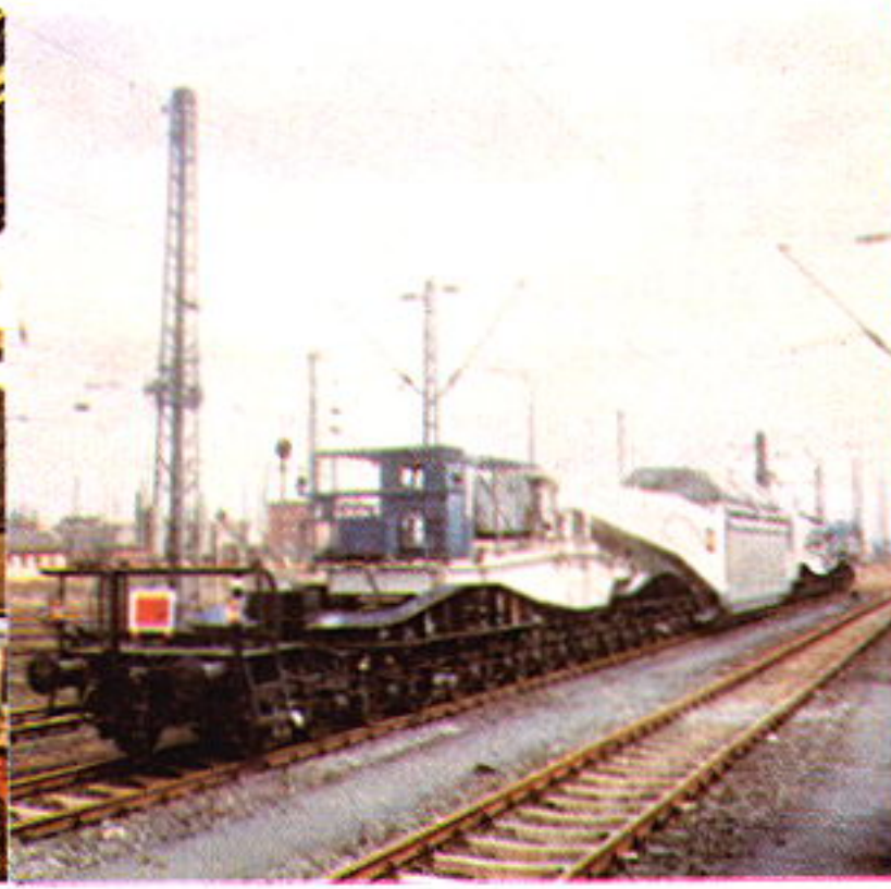
Schwersttransporter bis 400 t, läuft auf 32 Achsen
