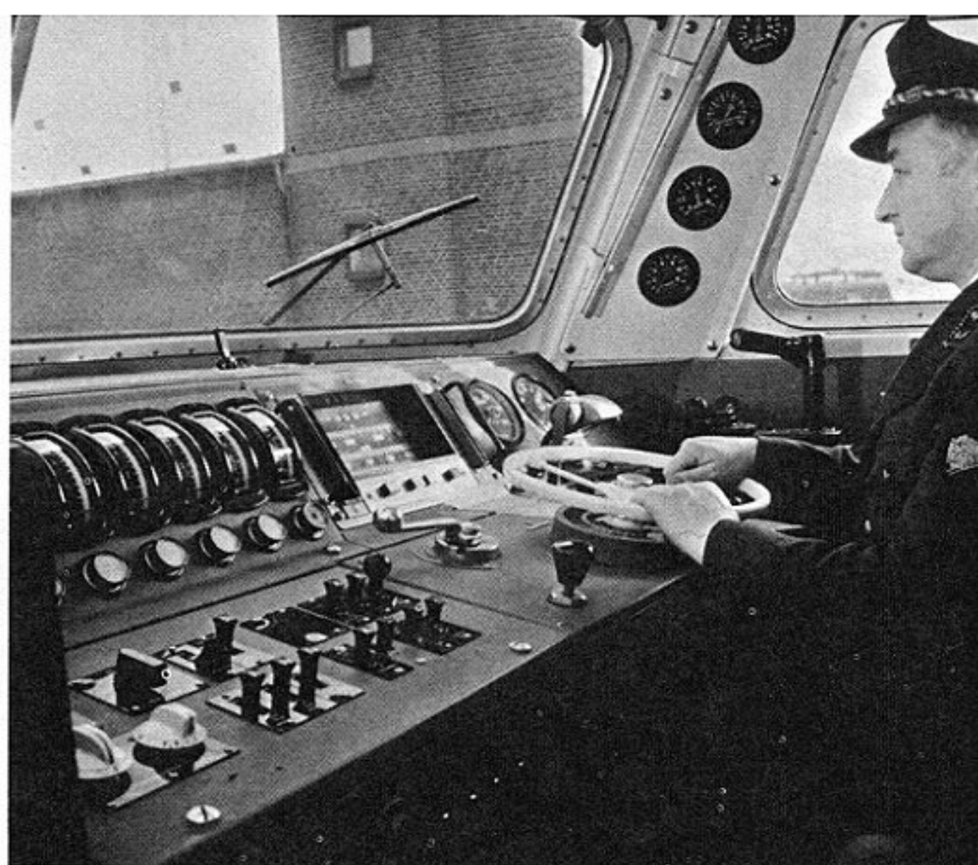
Führerstand einer modernen E-Lok: Neben der linken Hand des Lokführers der Totmannknopf, die drei Knöpfe in Höhe der Handkurbel gehören zu Indusi wachsam. Der rechteckige Tachometer (unter dem Scheibenwischer) gibt die Soll- und die Ist-Geschwindigkeit des Zuges an. Mit dem Fahrschalter, der wie ein Steuerrad aussieht, bestimmt der Lokführer die Geschwindigkeit des Zuges. Die beiden schwarzen Hebel an der Seitenwand rechts vom Lokführer sind die Bremsen
