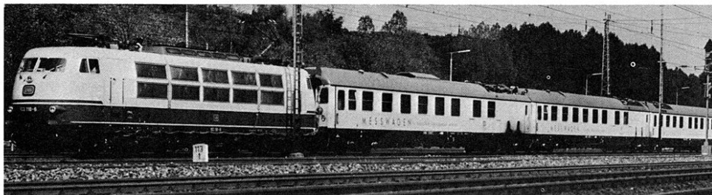
Mit 500 Ultraschallimpulsen pro Sekunde prüft dieser Meßzug die Gleise auf etwaige Materialfehler
