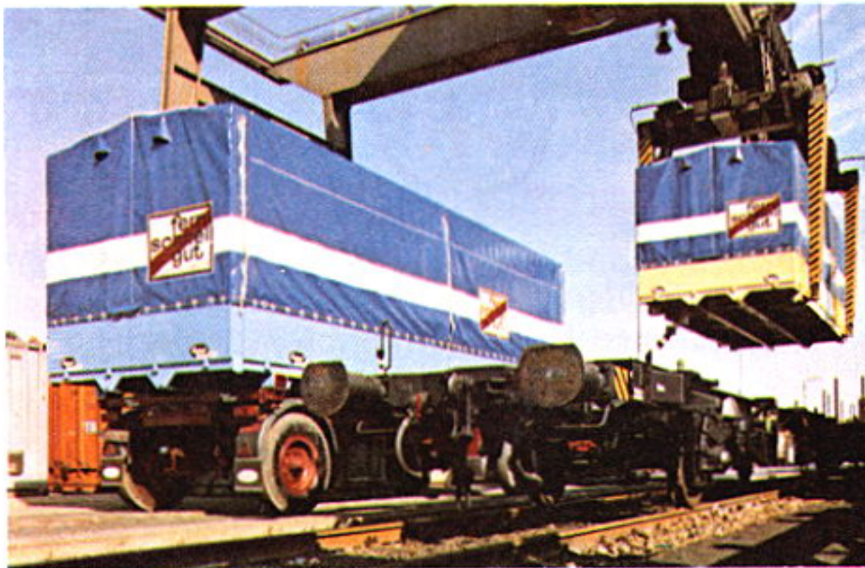
Traggestellwagen für Wechselkästen und Container zum Transport mit Zug und LKW
