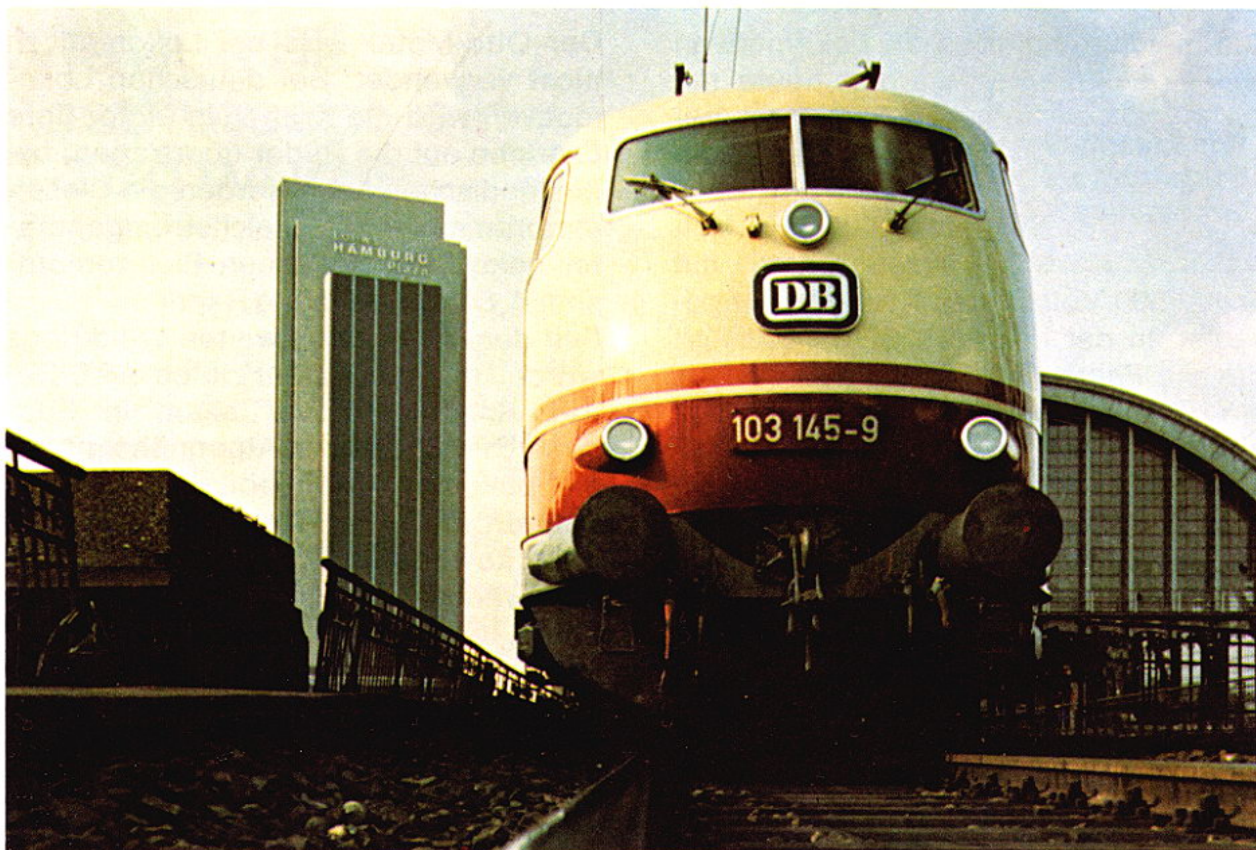
Das ist der Star der Bundesbahn: Die E-Lok Typ 103 (oben), Spitze 200 km/st, 14 000 PS. Jede 103 kostet 3,5 Mill. DM. Bei Tempo 120 verbraucht sie ebensoviel Strom wie 14 400 Glühlampen zu je 100 Watt. — Ein Dieseltriebwagen der Baureihe 612 (unten) verläßt in Puttgarden (Ostsee) die Eisenbahnhochseefähre
