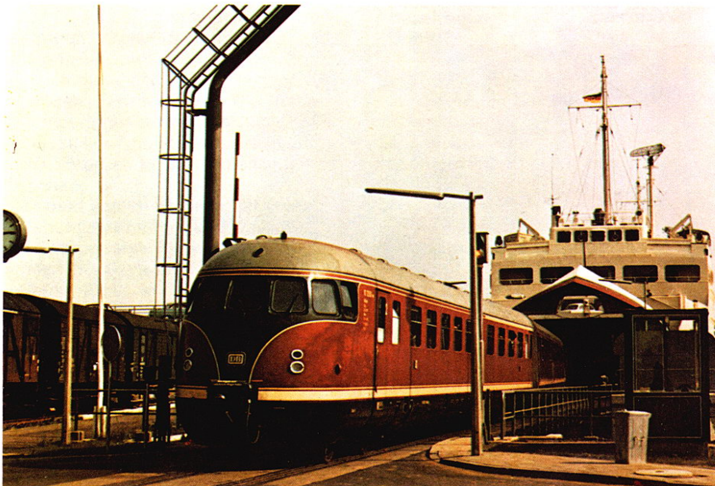
Das ist der Star der Bundesbahn: Die E-Lok Typ 103 (oben), Spitze 200 km/st, 14 000 PS. Jede 103 kostet 3,5 Mill. DM. Bei Tempo 120 verbraucht sie ebensoviel Strom wie 14 400 Glühlampen zu je 100 Watt. — Ein Dieseltriebwagen der Baureihe 612 (unten) verläßt in Puttgarden (Ostsee) die Eisenbahnhochseefähre
