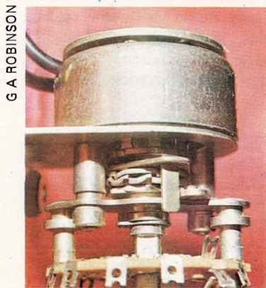
Oben: Ein Solenoid betätigt einen Drehschalter mit mehreren Kontakten. Der Elektromagnet schaltet Kontakte mit mechanischen Sperrklinken.
