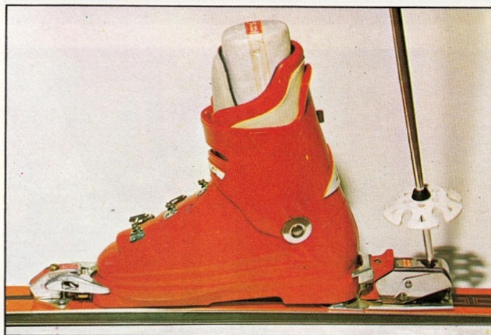
Oben: Eine moderne Sicherheitsbindung, die nach vorn und zur Seite, und zwar mit großer Zuverlässigkeit, auslöst. Zum Öffnen der Fersenautomatik drückt man, wie im Bild gezeigt, mit der Stockspitze auf den Öffnungshebel.
