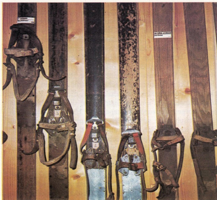
Oben: Bindungen aus den ersten Jahren unseres Jahrhunderts. Sie haben Sohlenhalter, bei denen der Schuh von einem Lederriemen, der über die Schuhspitze geführt ist, gehalten wird. An der Ferse haben diese Bindungen statt eines Federdrahtseils auch einen Lederriemen. Die Bindungen an den beiden links gezeigten Skipaaren wurden über Metallverschlüsse geschlossen, während das Paar rechts buchstäblich angeschnallt wurde.
