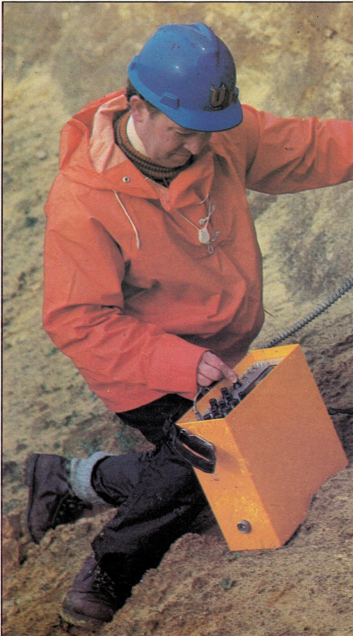
Ein Spektrometer, das vier Gammastrahlkanäle hat und für die Suche nach Uran, Thorium und Kalium sowie Bohrlochvermessungen eingesetzt wird.
