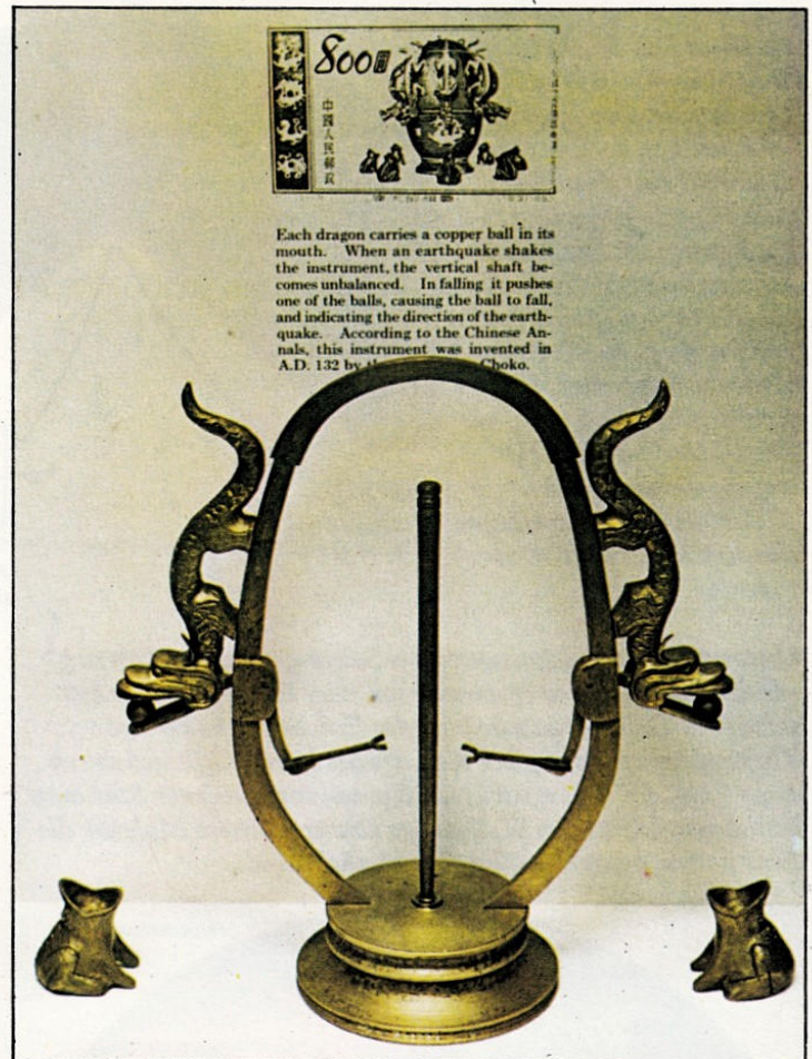
Oben: Eine Nachbildung des Seismometers von Tschang Heng. Bei einem Erdstoß fällt der Stab und bewirkt durch ein Hebelsystem das Öffnen eines Drachenmauls, wodurch die Kugel herausfällt.
