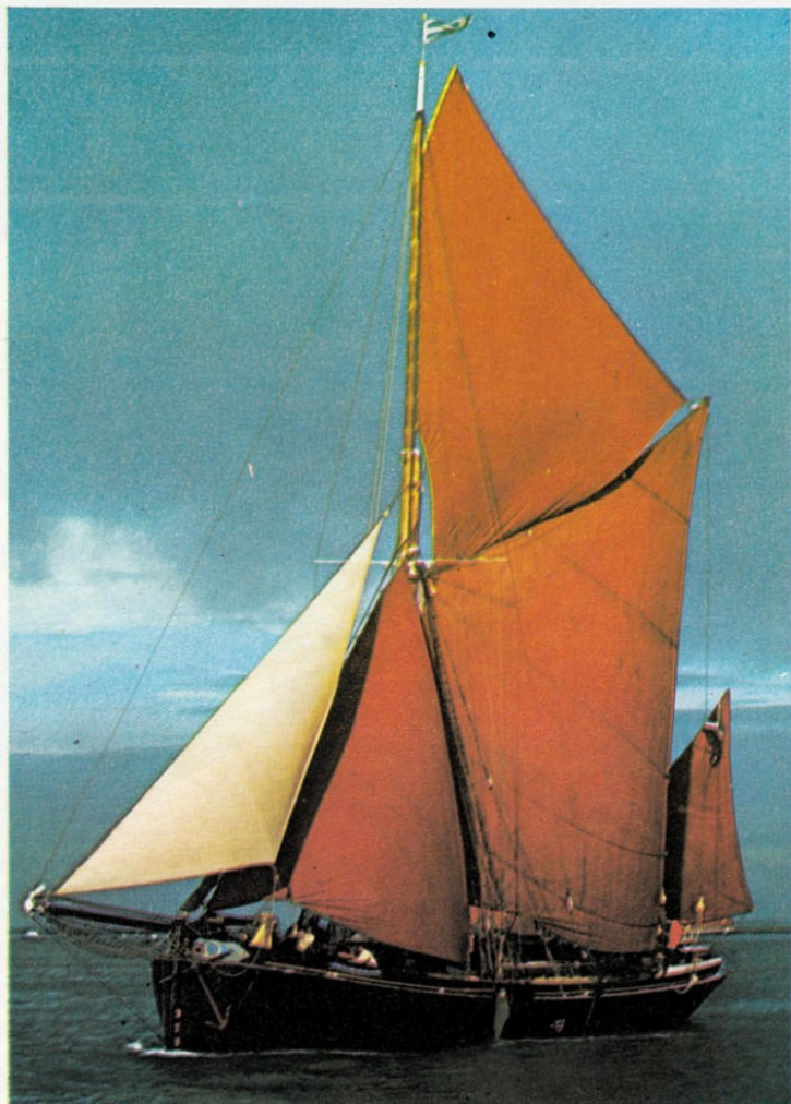
Bei Verwendung eines Bugspriets, einer Spiere, die vom Bug nach vorn ragt, kann das Schiff eine weitere Fock führen.
