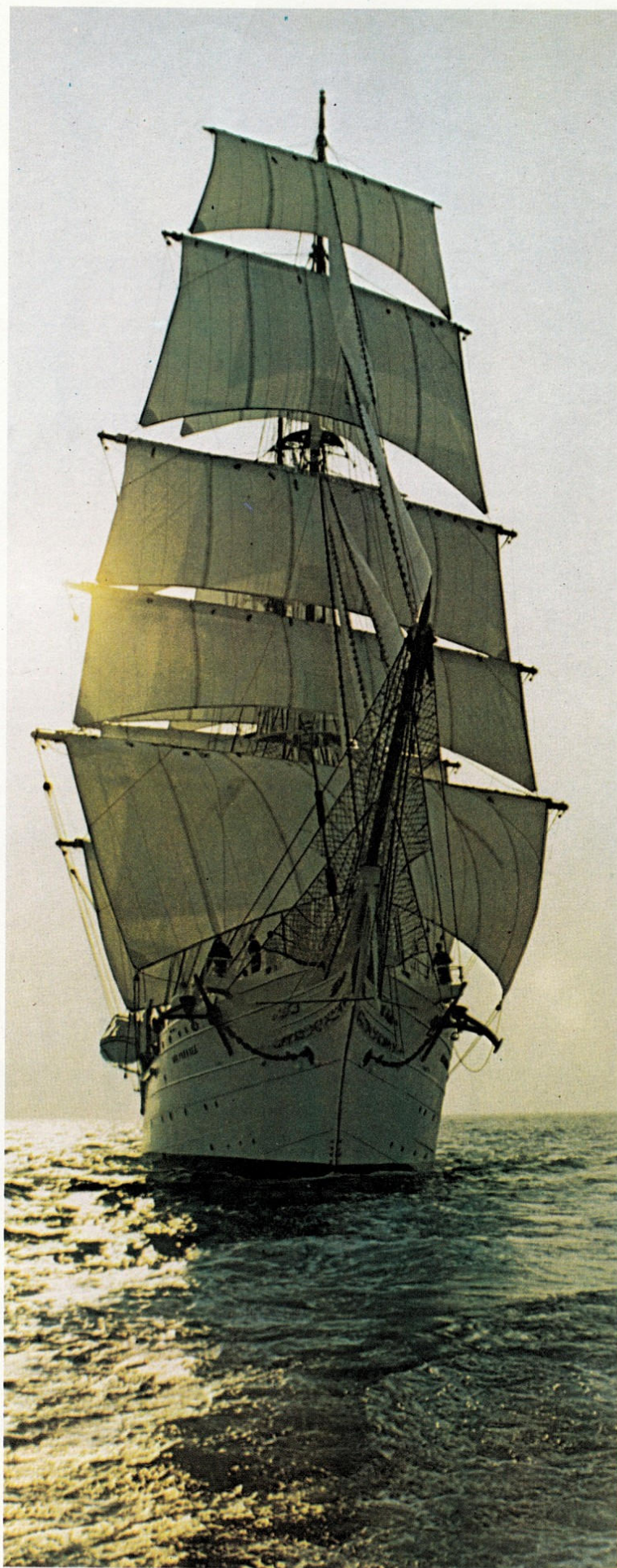
Oben: Das polnische Rahschiff 'Dar Pomorza' vor dem Wind im Ärmelkanal. Das Wort 'Schiff' hat hier eine besondere Bedeutung, denn strenggenommen sind Schiffe vollständig rahgetakelt, mit Toppmast und Bramstenge.
