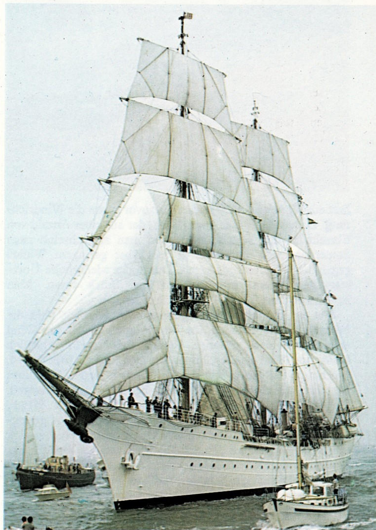
Oben: Die Bark 'Eagle' der amerikanischen Küstenwacht während der Großschiffregatta ('Windjammerregatta') von 1972. Eine Bark hat am Besanmast keine Rah- sondern Schratsegel.
