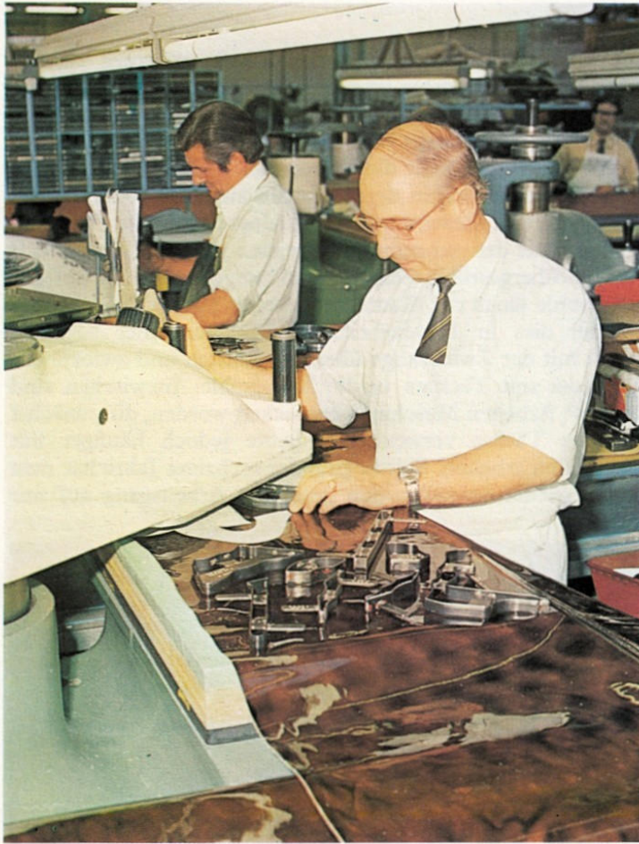
Oben: Zuschneiden der Einzelteile für die Schäfte auf einer modernen Fertigungsstraße. Die Maschine kann mehrere Stücke gleichzeitig schneiden.
