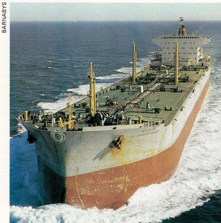
Oben: Ein Super-Öltanker. Die Pumpen eines solchen Tankers können eine Förderleistung von 10 000 t/h haben, die das Laden oder Löschen innerhalb von 24 Stunden ermöglichen.
