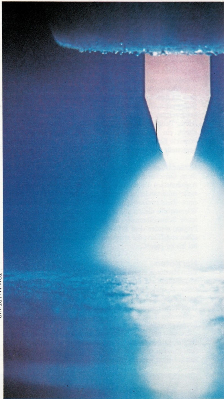
Oben: Uneingeschnürter Argonlichtbogen. Das Edelgas Argon verhindert eine Oxidation des Metalls. Da die meiste Wärme an der Anode erzeugt wird, wird das Werkstück normalerweise als positiver Pol geschaltet — und dadurch auch ein Selbstverzehren der Elektrode vermieden.
