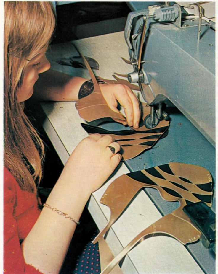
Oben: In der Stepperei. Die einzelnen Schaftteile werden auf einer Spezialnähmaschine zusammengenäht.
