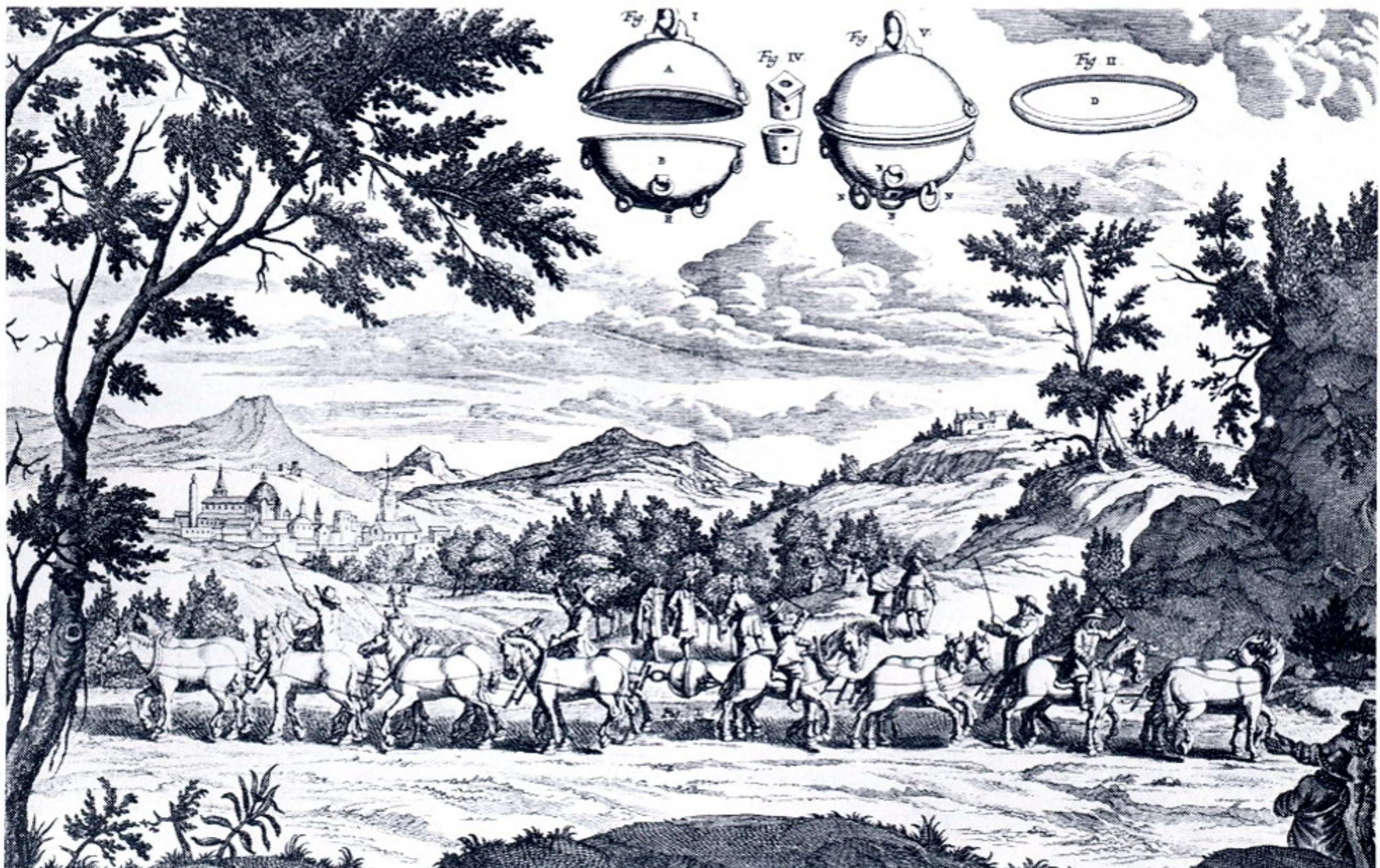
Erst 16 Pferde konnten die von Otto von Guericke luftleer gepumpten beiden Halbkugeln auseinanderreißen. Damit hatte der Magdeburger Bürgermeister die Kraft des Luftdrucks bewiesen.
