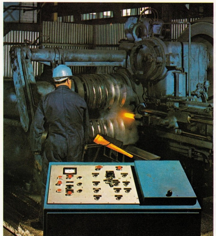
Oben: Walzschmieden, hier eine konische Form. Die Walzen (Rollen) sind wie Riemenscheiben geformt. Die eingearbeitete Nut dient zur Herstellung der gewünschten Form.
