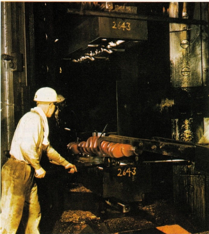
Oben: Eine geschmiedete Kurbelwelle wird aus dem Gesenk genommen. Das Obergesenk ist leicht zu erkennen. Man kann jede Form gesenkschmieden, sofern sie sich aus dem Gesenk nehmen läßt.
