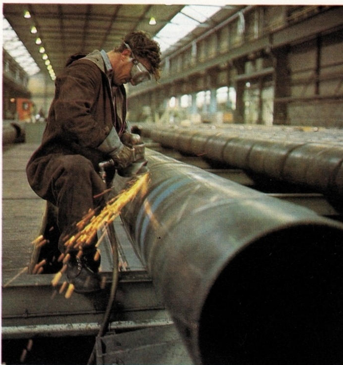
Oben: Das Abschleifen einer Schweißnaht an einer Röhre in einem Röhrenwerk der British Steel Corporation. Die dabei verwendeten Schleifscheiben müssen härter als der bearbeitete Qualitätsstahl sein.
