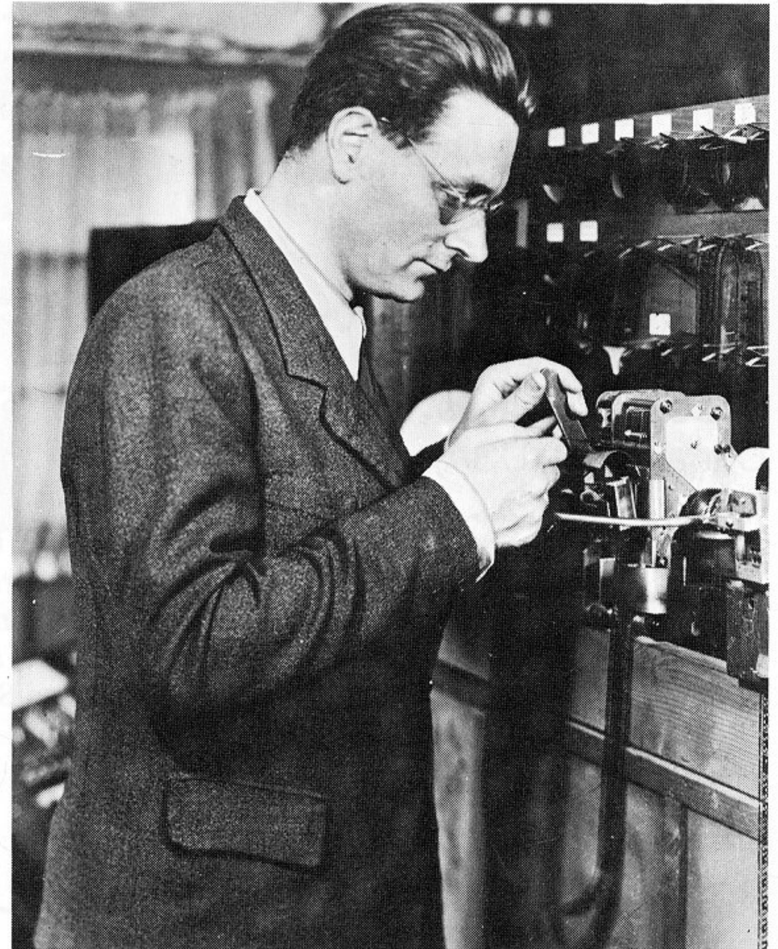
Konrad Zuse 1950 vor seiner Rechenmaschine. Sie wurde mit Lochstreifen gesteuert und war der erste Dualsystem-Rechner der Welt.
