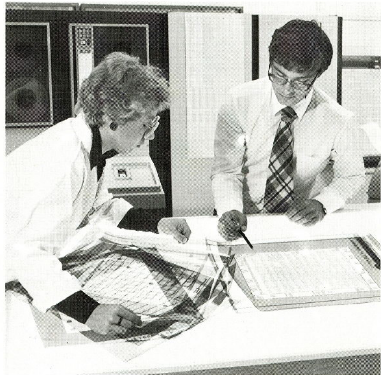
Das „Innenleben“ eines IC wird meist mit Hilfe eines Computers in vergrößertem Maßstab entworfen.
