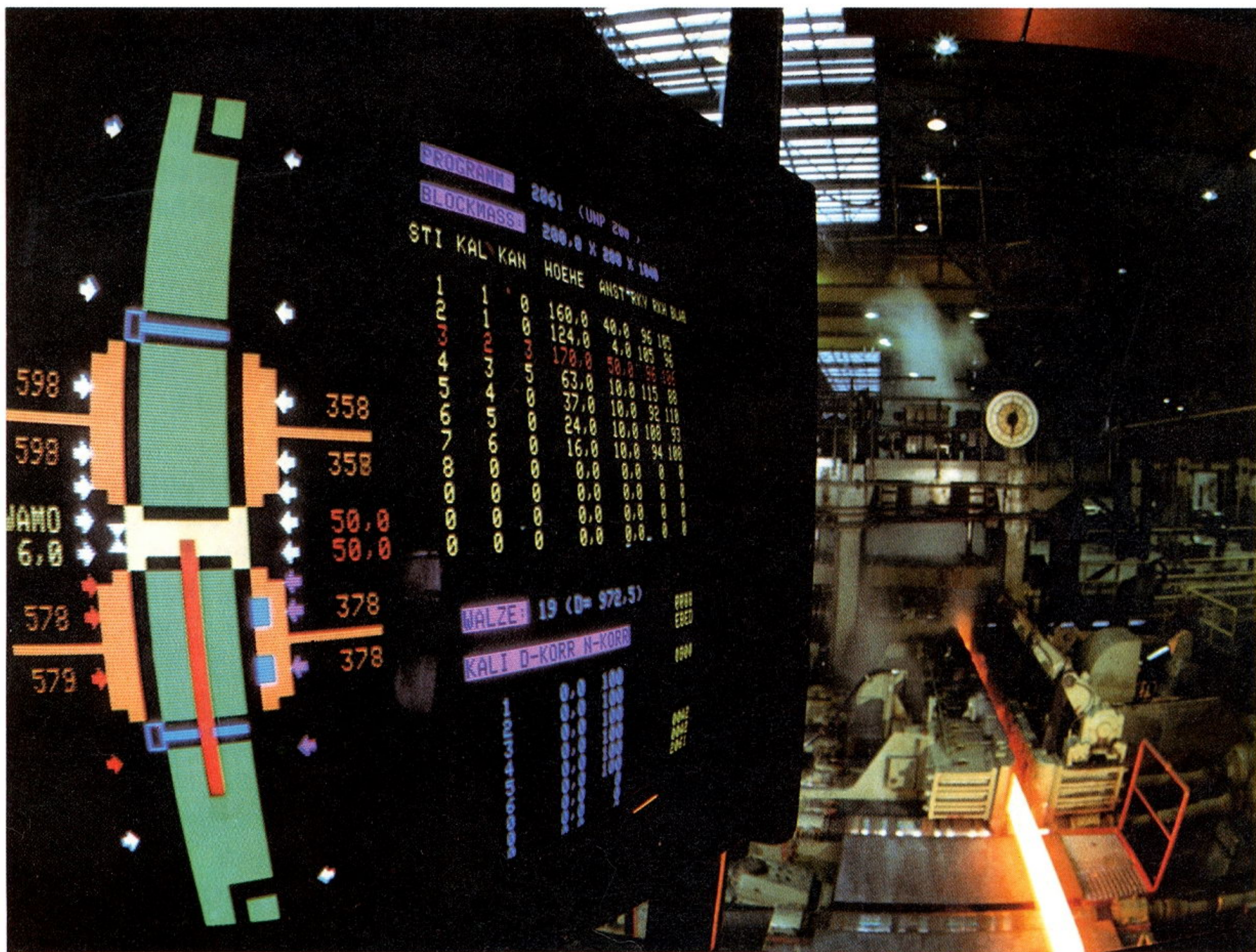
In diesem Walzwerk überwacht ein Computer mit über 2000 Meßwerten den Produktionsablauf. Er vergleicht ununterbrochen Soll- und Ist-Werte; stimmen sie nicht überein, schlägt er Alarm und zeigt den Fehler an; bei einigen Geräten korrigiert er den Fehler über einen Regler selbst.
