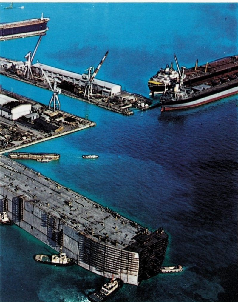
Links: Ein 276 000 t Supertanker im Bau. Das Schiff wurde auf einer japanischen Werft im Trockendock gebaut, das zum Stapellauf einfach geflutet wurde.
