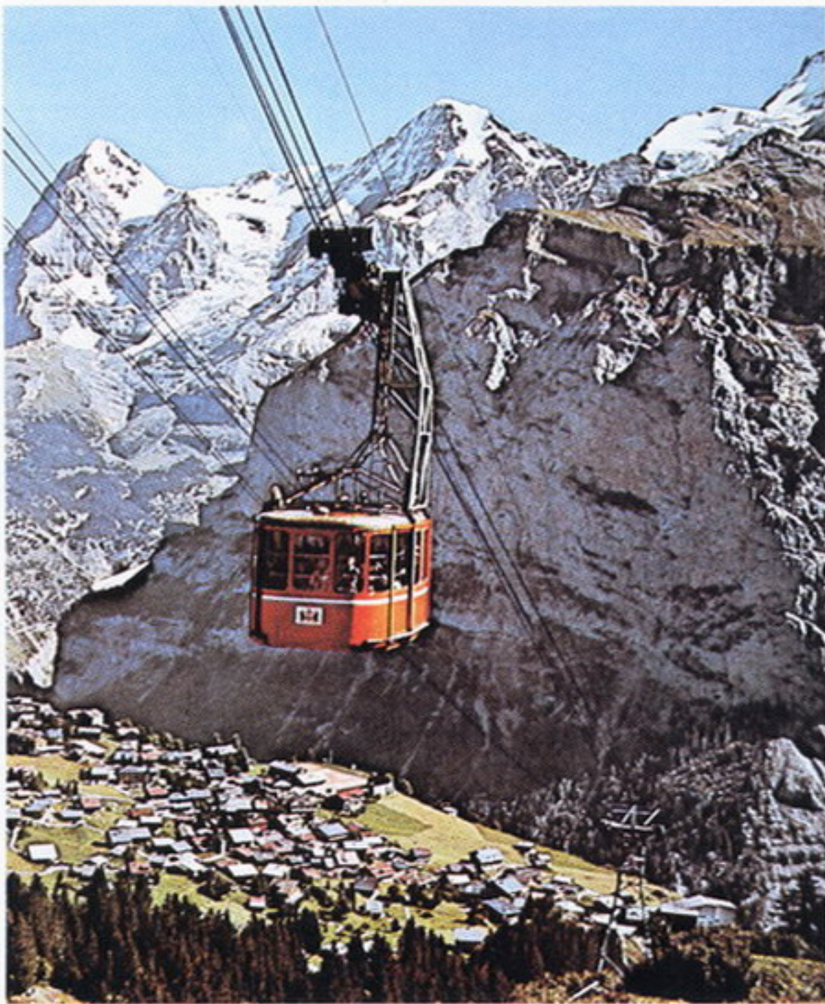
Die Gondeln einer Seilbahn — hier die Schilt-hornbahn bei Mürren (Schweiz) — hängen an einer schiefen Ebene. Die Maschinen, die die Gondeln aufwärtsziehen, brauchen weniger Kraft.
