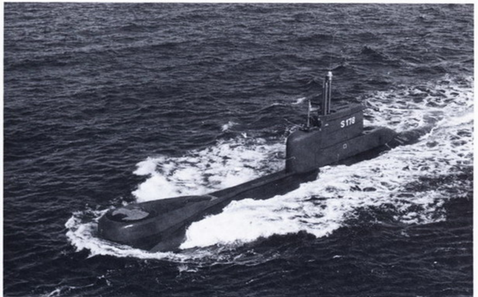
Unterseeboote haben Ballasttanks, die mit Wasser gefüllt oder leergepumpt werden können. So läßt sich der Auftrieb regulieren. Auf der Zeichnung links sind die Tanks fast voll. Rechts: Ein deutsches U-Boot der Klasse 206, eines der modernsten Schiffe der westlichen Kriegsmarinen.
