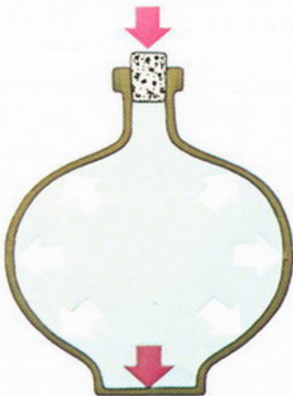
Das Wasser drückt mit dem gleichen Druck auf die Wandung wie der Korken auf das Wasser.
