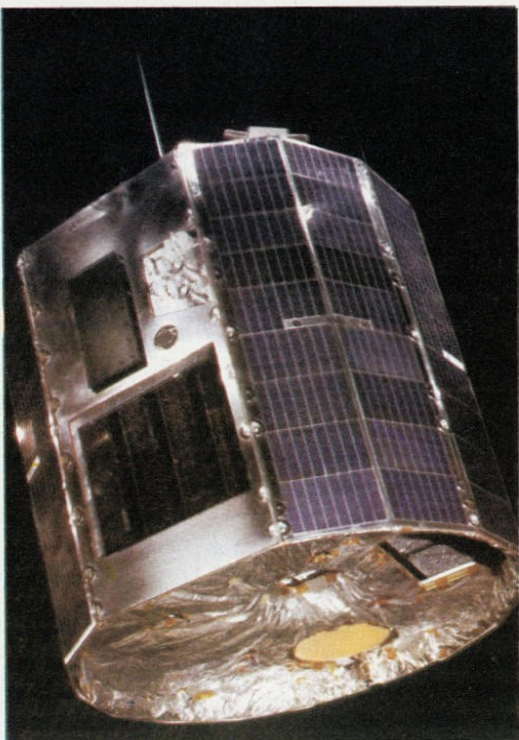
Unten: Der britische Röntgensatellit 'Ariel 5' wurde 1974 mit einer amerikanischen Rakete in eine Erdumlaufbahn gebracht. 'Ariel 5' ist mit Teleskopen und Detektoren ausgestattet, die Röntgenstrahlen im Weltraum, oft von fernen Sonnensystemen kommend wie der Seyfert-Galaxie und Quasaren, messen.
