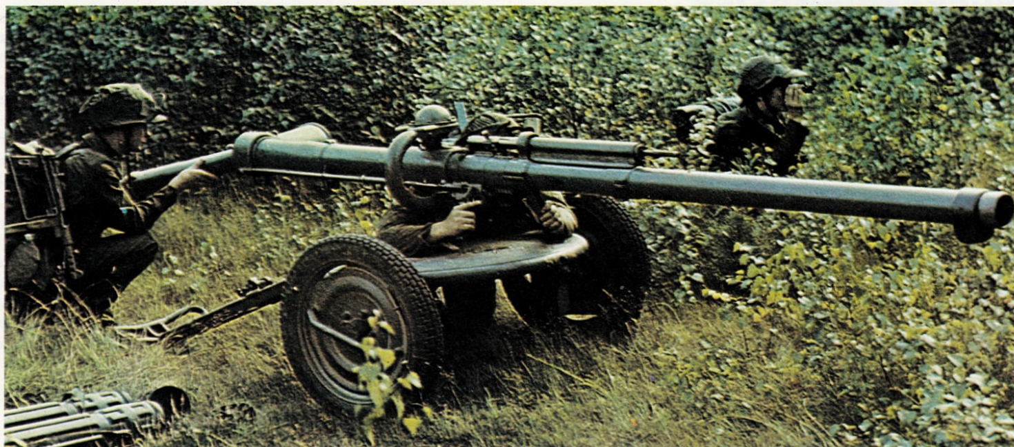
Ein rückstoßloses Bofors-90mm-Geschütz. Die Schußgeschwindigkeit beträgt 6 Schuß pro Minute. Die rund 3 kg schweren Projektile können 38 cm dicke Panzerungen durchschlagen.
