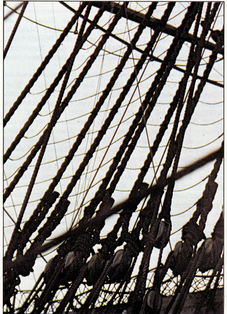
Oben: Taljen in der Takelage des britischen Kriegsschiffes 'Victory', aus dem 18. Jahrhundert. Taljen wurden zum Setzen und Niederholen der Segel gebraucht.
