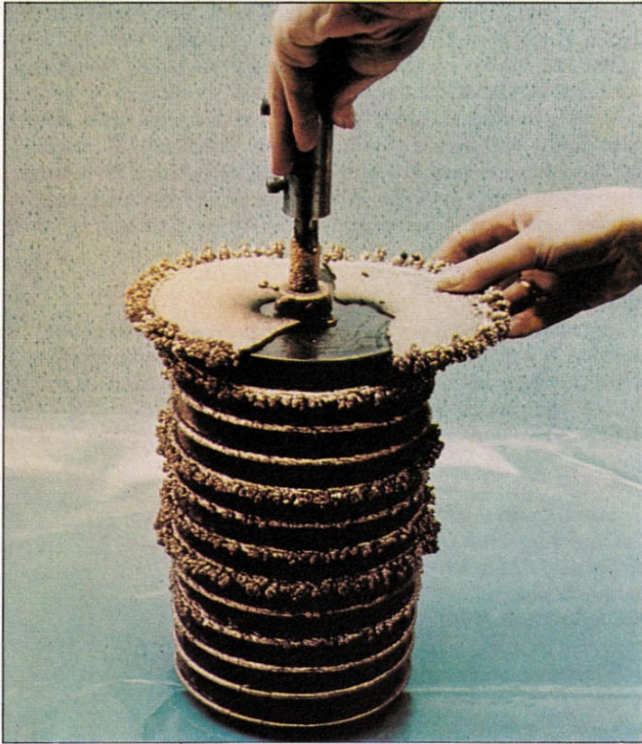
Oben: Silber wird aus benutzten fotografischen Lösungen durch einen elektrolytischen Vorgang zurückgewonnen. Das Bild zeigt wie Silber von der Katode der Anlage abgehoben wird.
