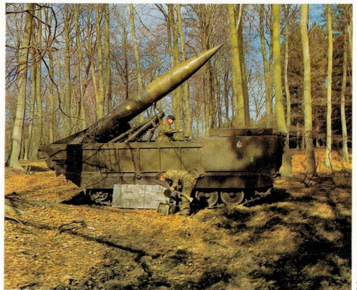
Oben: Die Lance Boden-Boden Rakete. Sie wird von einer Amphibienabschußrampe (die Eigenantrieb hat) abgeschossen.
