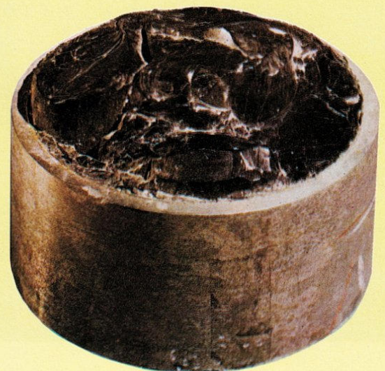
Oben: Ein Teil des glasigen Abfallstoffes mit Stahlummantlung.
