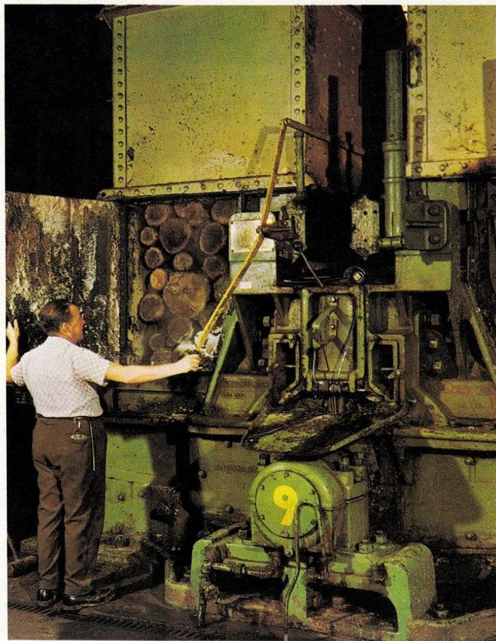
Oben: Entästete und entrindete Stämme in der Mahlmaschine. Links unten: Das gemahlene Holz wird zum Zellstoffkocher gefördert.
