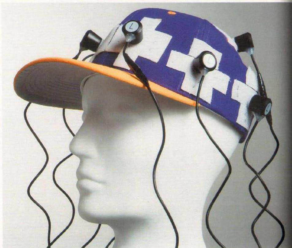
Stimmen hören, eine fremde Präsenz spüren: Die acht Magnetspulen des »Shakti 8-Coil-Set« erzeugen mithilfe der Soundkarte eines PC elektromagnetische Felder; diese sollen Hirnbereiche stimulieren, die angeblich für Gottesehrungen empfänglich sind
